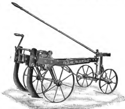
Fig. 9. Rübenheber von Fr. Dehne-Halberstadt.
