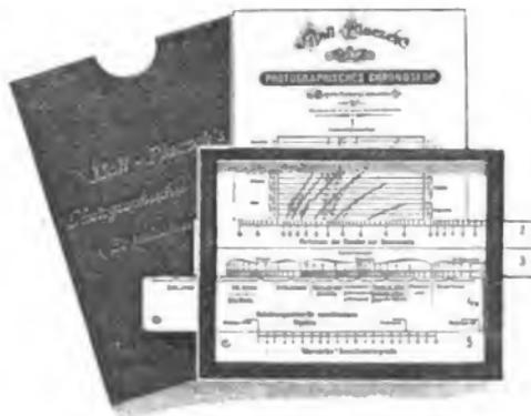
auf der Anwendung von Helligkeitscurven des Lichtes zu verschiedenen Tages- und Jahreszeiten, combinirt mit Schieberscalen, in welchen das Verhältniss vom Blendendurchmesser zur Brennweite  $\frac{d}{f}$ , dann die Art der Aufnahmeobjecte (Landschaften, Interieurs etc.) aufgetragen und auch die Plattenempfindlichkeit in Warnerke-Graden angebracht ist. Wenn auch dasselbe Problem von verschiedenen Seiten (namentlich von Eng-
