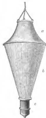
Hensen'sches Planktonnetz. a undurchlässiger Stoff; b filtrierender Zell; c Eimer.
