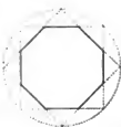
Fig. 3 Construction des Achteckes aus der sogenannten Quadratur. (Construotion und ästhetische Arbeit mit dem Quadrate.)
