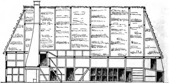
Fig. 10. Längsschnitt eines Hauses in Velpke von 1678. 1894 abgebrochen; bei a die nach der Däle zu offenen Ställe.
