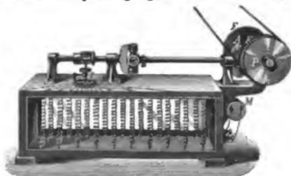
Prinzip beruht: Die beiden Punkte, die auf konstanter Spannung gehalten werden sollen, z. B. die Klemmen der Dynamomaschine oder zwei beliebige Punkte des Leitungsnetzes, sind mit den beiden Enden einer Drahtspule verbunden. In der letzteren ist ein bifilar aufgehängter Eisenkern frei beweglich. Der Kern hängt, wenn die normale Spannung vorhanden ist, nicht symmetrisch zur Mitte der Spule; steigt die Spannung, so
