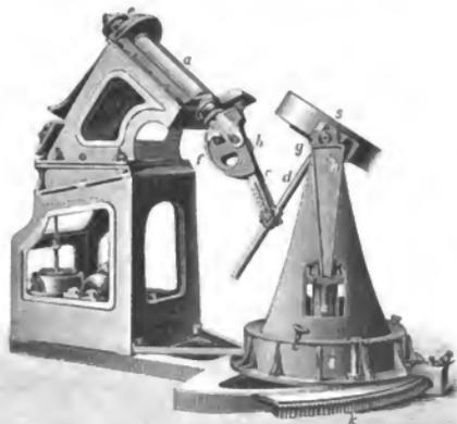
naemlich für gewisse Stellungen des Spiegels, häufig nicht der Fall ist. Zu diesem Zweck ist das Instrument mit einem sehr kräftigen, für die Bewegung eines zwölfzölligen Refraktors hinreichenden Uhrwerk versehen, an dem noch zur Erzielung eines bis auf 0,025 Sekunde genauen Ganges die automatische Kontrol- und Korrigirvorrichtung angebracht ist, welche vom Verfasser bei den für die Himmelsphotographie gebauten Fernrohren angewandt und in *dieser Zeitschr. 1888, S. 328*, beschrieben worden ist.
