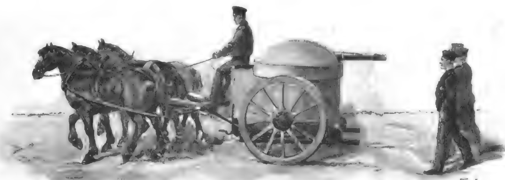
Fig. 7. Fahrbare Panzerlafette für eine 3,5-Cmtr.-Schnellfeuerkanone.
