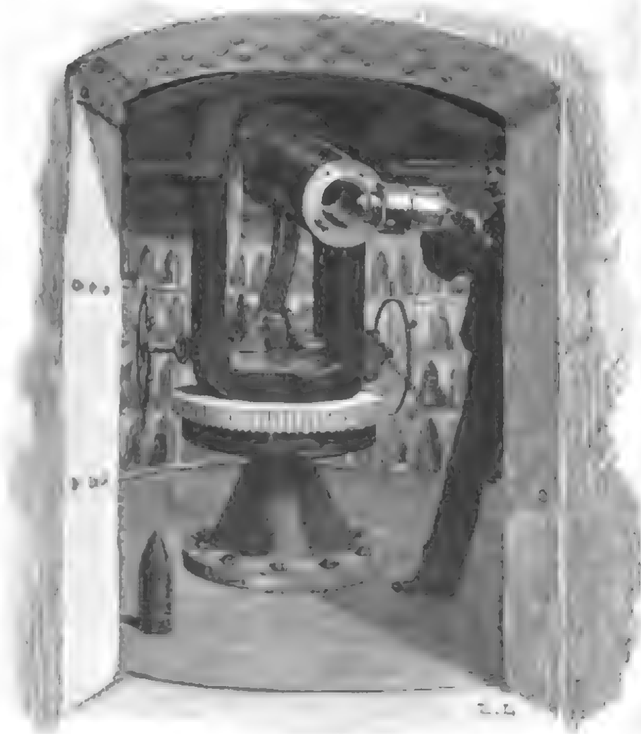
Fig. 8. Das Innere einer Panzerlafette für eine 12-Cmtr.-Kanone.
