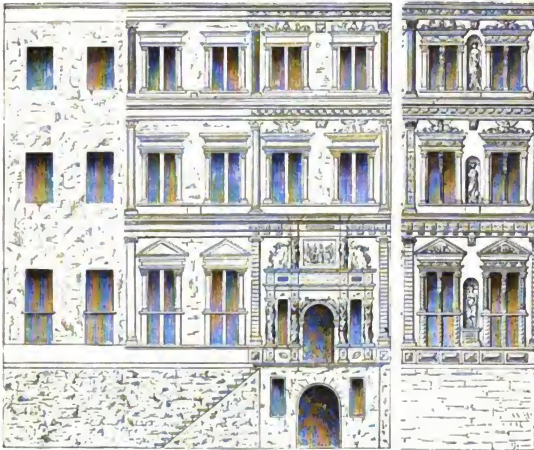
Fig. 12. Entwicklung einer Fassade vom Speicher bis zum Prachtbau.
