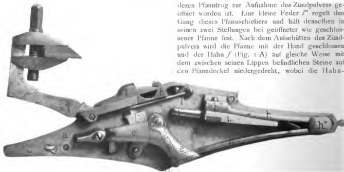
Fig. 1 B. Deutsches Radschloss. Innere Ansicht.
