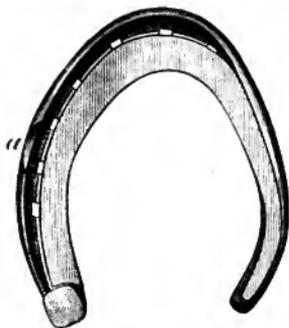
Fig. 2102. Streicheisen mit einseitiger Lochung für den rechten Hinterhof, a Seitenkappe.
