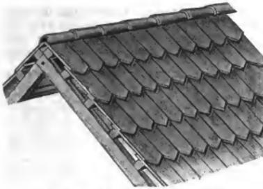
Fig. 1933 a. Einfaches Flachziegeldach.
