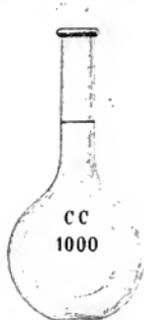
Fig. 2119. Messkolben.
