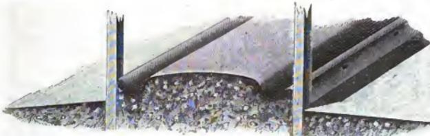
Fig. 2014. Doppelter Futtertisch, zugleich erhöhter Futtergang.
