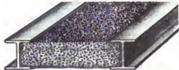
Fig. 1950. Eisenbalken mit Cementgussausfüllung.
