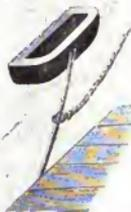
Fig. 2052. Befestigung an einem Eisenstab mittelst Ring.
