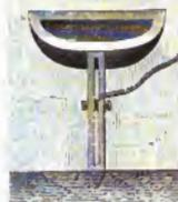
Fig. 2053. Befestigung an einem Holzklötz, hinter Holzleisten gleitend.
