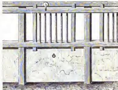
Fig. 2009. Verschiebbare Gitterwand, geschlossen.
