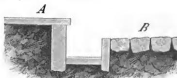
Fig. 1977. Hohes Lager. A Lager, B Stallgang.
