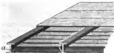
Fig. 1954. Zwischen Eisenbalken gelegte Backsteinhurden. a Ausfüllung mit Cement.
