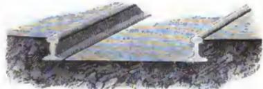
Fig. 2013. Eisenschienen für Futterrollwagen.
