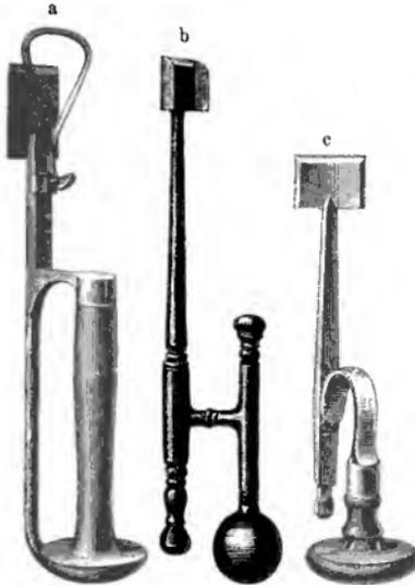
Fig. 2096. a schwedisches Stossmesser mit Sicherung, b altddeutsches Stossmesser, c deutsches Stossmesser.
