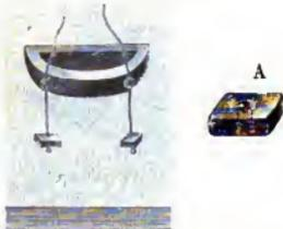
Fig. 2051. Befestigung an Riemen mittelst Holzklötzen. A Holzklötz.
