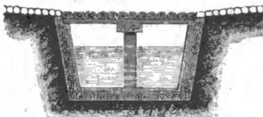
Fig. 1897. Mistjauchebehälter mit Rundholzdecke.
