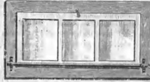
Fig. 2056. Breites Stallfenster mit unten stehender Drehaxe.
