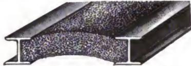
Fig. 1948. Eisenbalken mit Cementgewölbe.
