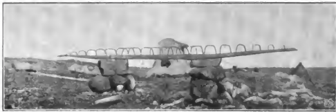
Kajak im Bau
