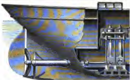
Fig. 1. Zwillingschraubenschiff. Zum Teil Durchschnit.
