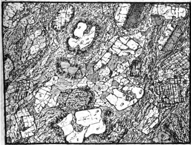
Fig. 9. — Argilolite silicifiée de la Vêche (Grossissement 80 diam.)
