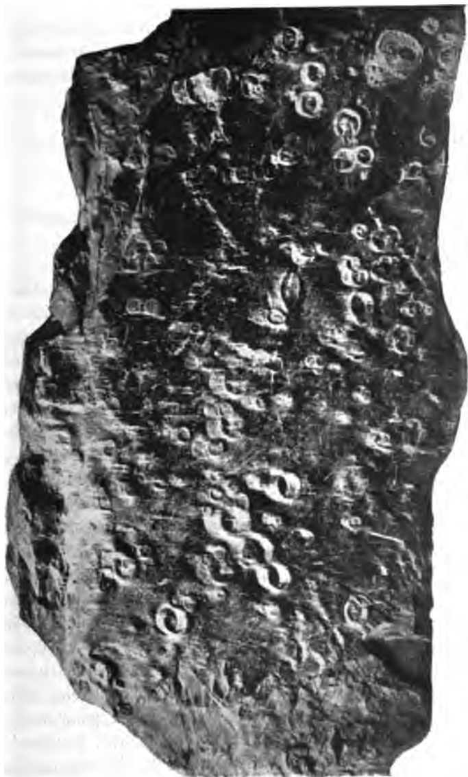
Fig. 1. — SURFACE DE GLISSEMENT D'UN SCHISTE DU TOIT DE LA VEINE Grande Moisa , AU CHARBONNAGE DE LA HAYE, MONTRANT L'INSCRIPTION DU MOUVEMENT SUBI PAR LA ROCHE.
