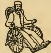
FAUTEUIL avec grandes roues caoutchoutées mû par 2 manivelles.
