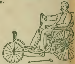
VOITURE à LEVIER actionnée et dirigée au moy. d'une seule main.
