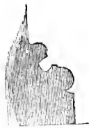
Base of Shaft, Piscina.
