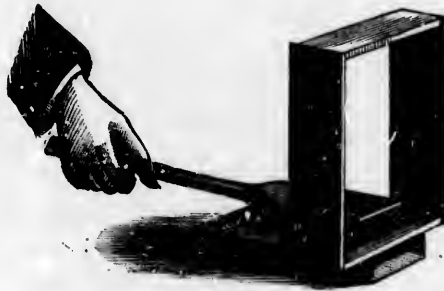
(Fig. 40) — Machine de Parker pour fixer la fondation.
