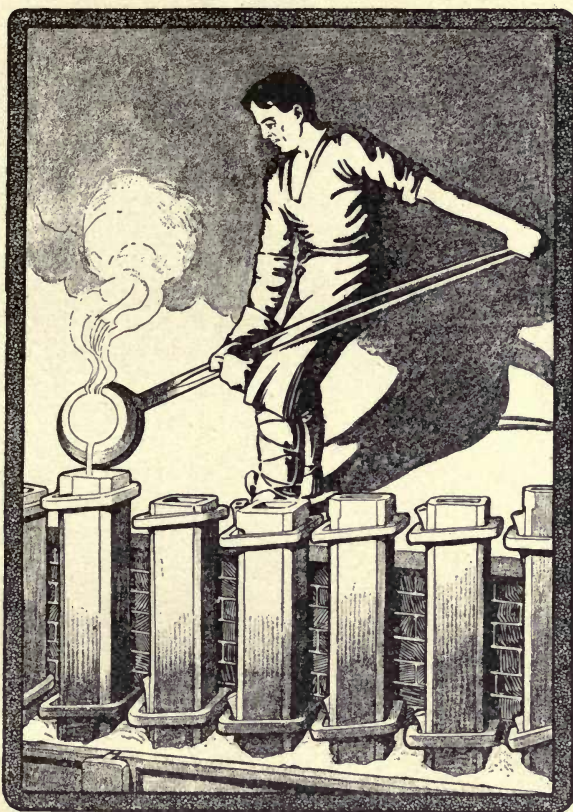
FIG. 28. — Pouring ingots from crucibles.
