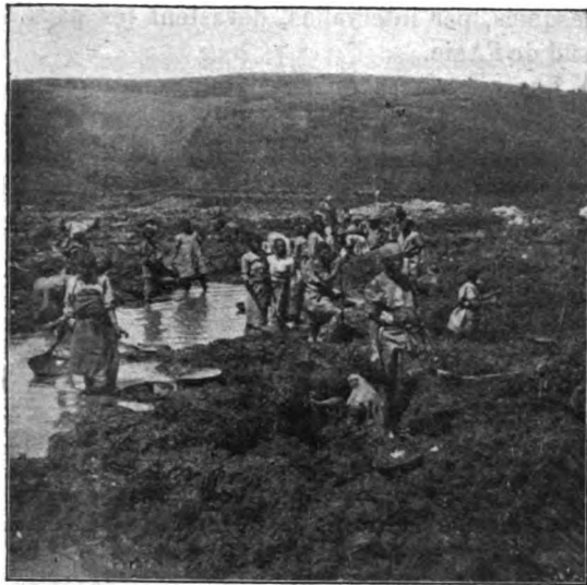
Exploitation de l'or dans le sud du Betsiléo; procédé de la battée.
