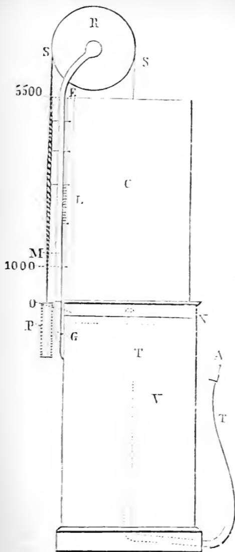
FIG. 109. — Spiromètre de Schnepf<sup>2</sup>.
