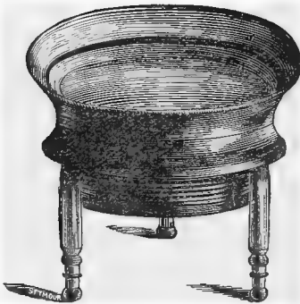
FIG. 26.—TRIPOD MAGNIFIER; \times 1 ; § 168.
