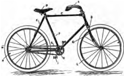
Cykle. A Styr. B Kronestykke. C Topprør. D Sadel. E Baggeffel. F Sadelstøtte. G Forgeffel. H Crankleje. I Pedal. K Kæde. L Fiælg. M Gummiirg. N Ventill.
