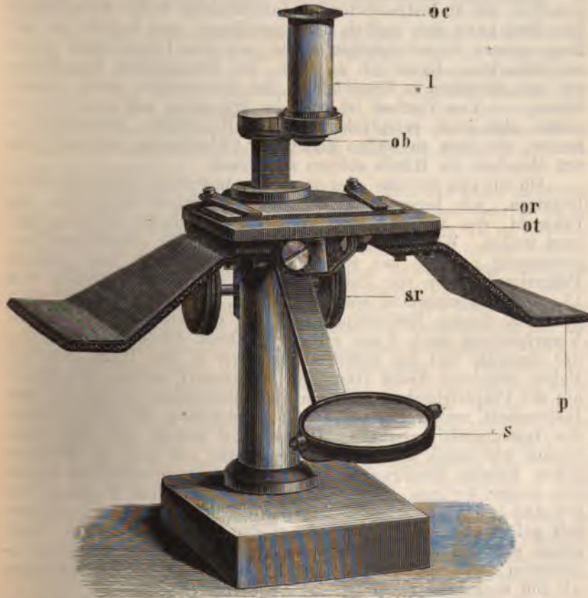
Fig. 19. Grosses Präparir-Mikroskop von Zeiss, \frac{1}{2} natürlicher Grösse. ot Objectivtisch, p Präparirbacken; sr Schraubenköpfe; l Linsensystem, an diesem ob das Objectiv; oc das Ocular. Auf dem Objectivtisch liegt ein mit Federklammern befestigter Objectträger.
