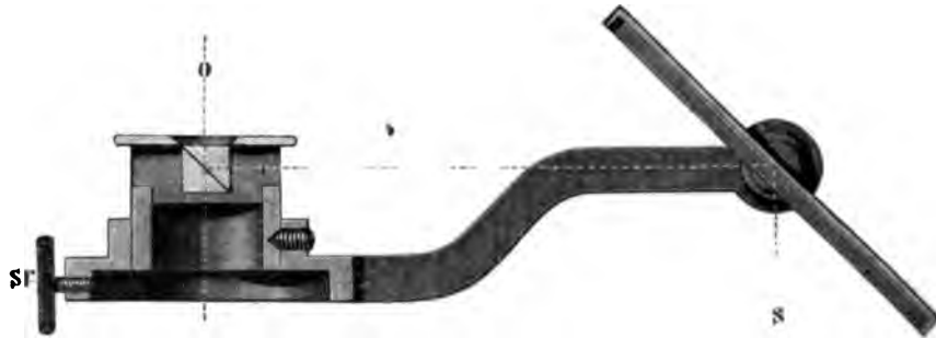
Fig. 22. Camera lucida nach Abbe, in natürlicher Grösse. Idealer Längsschnitt. Der Strahlengang durch Linien angegeben. o die Richtung zum Auge; s zur Zeichenfläche; sr Klemmschraube.
