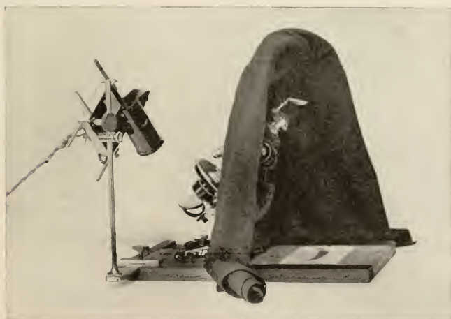
Fig. 14. Zeichenspiegel mit Klemmring nach EDINGER beim Gebrauch.
