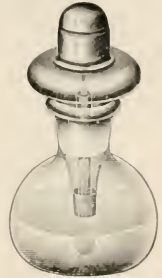
Fig. 1. Fläschchen für Immersionsöl und die zugehörige Reinigungsflüssigkeit von Zeiss . Ca. \frac{1}{2} nat. Größe.
