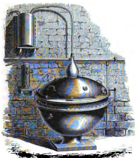
Fig. 224. Verbesserter Apparat zur Destillation ätherischer Öle.
