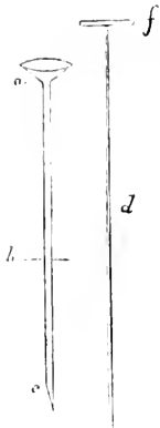
Fig. 58. Toestel om vloeistoffen in den bodem te brengen.
