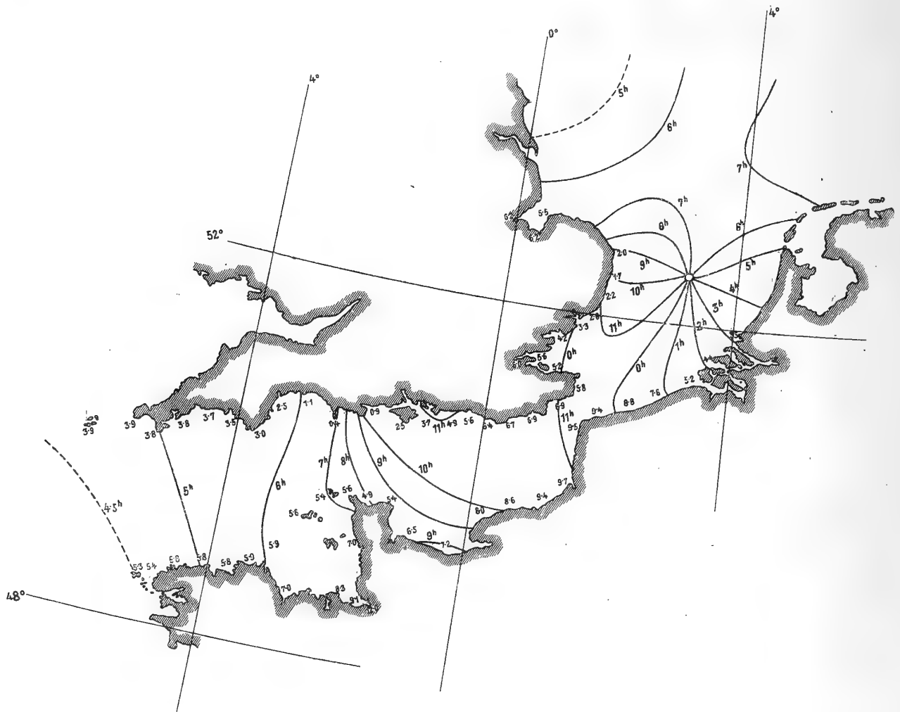
Theoretische Flutstundenlinien (Mondstunden) im Verbindungskanal Atlantischer Ozean—Nordsee und theoretische Hubhöhen ( m ) der Gezeiten bei Springflut an einzelnen Küstenpunkten.
