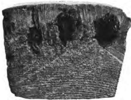
Fig. 33. Stück eines Balkens, in dessen Splintrisse Pilzsporen eingebracht sind. Das aus ihnen entwickelte Mycel führt zur Zersetzung des Holzes von den Rissen aus und hat an drei Stellen große Höhlen gebildet.
