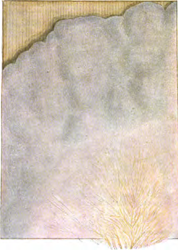
Fig. 9. Kräftig entwickeltes Mycelium des Hauschwamms, auf welchem bei Lichtwirkung Fruchträgerbildung zu entstehen pflegt. Im unteren, älteren Teile ist dasselbe zusammengelassen, während gleichzeitig reich verästelte weiße oder gelblich gefärbte Stränge darin entstanden sind. Das dem Holzstücke eng anliegende ältere Mycel hat eine schmutziggraue Färbung angenommen, während das lockere, watteartige Mycel einen hellen, rötlichen Schein besitzt. \frac{1}{2} nat. Größe.
