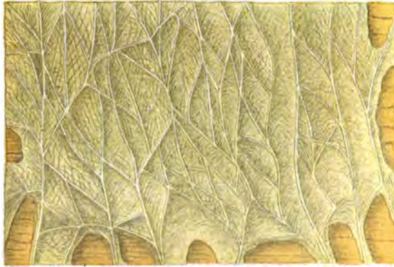
Fig. 23. Dasselbe Brett wie Fig. 24, von der Unterseite gesehen. Aus dem häutigen, rauchgrauen Mycel haben sich zahlreiche, feine Stränge von weißer und gelblicher Farbe ausgeschieden. \frac{1}{4} .
