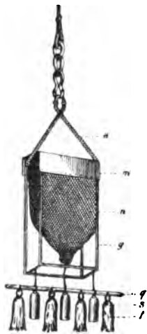
Fig. 2. a Hängestange. m Schabern. n Netz. g Rahmen. g Querstange. s Gewichte. t Quasten.
