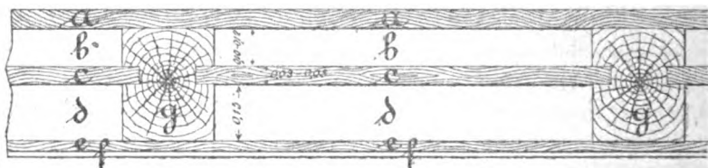
a Fussbodendielung. e Schaalbretter b Lehm mit Stroh. f Deckenputz. c Schwarten resp. Knüttel. g Etagenbalken. d Freier Raum.
