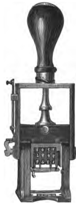
Fig. 147. Handnumérateur mit Selbstfärbung.
