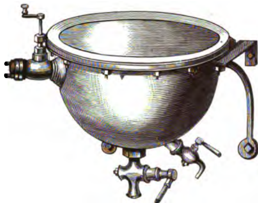
Fig. 26. Dampfkochapparat für Walzenmasse. (Modell Hogenforst.)
