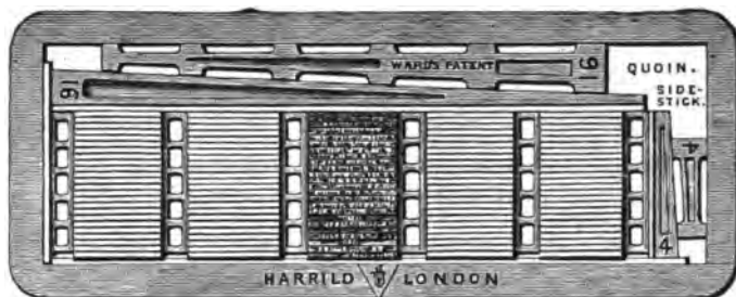
Fig. 86. Eine mit eisernen Keilstegen von Harrild & Sons geschlossene Form.
