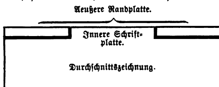
Fig. 126. Befestigung der Congreveindruckplatten.
