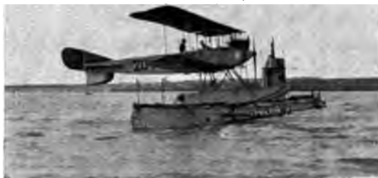
Abb. 287. Versuch im Frühjahr 1915, Flugzeuge auf U-Booten wegen zu geringen Aktionsradius näher an die englische Küste heranzubringen.
