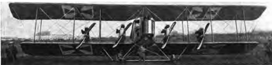
Abb. 81. Siemens-Schudert R-Veruch (s. Tab. III, Nr. 52), Typ 1914, dem „Sidorov“ in der bezentralen Motorenanordnung ähnlich. 140 qm Tragfläche. Geschlossene Kabine.
