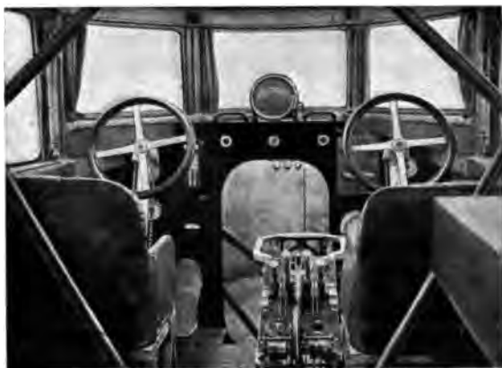
Abb. 90. Doppelführeritz zu Abb. 87 mit Instrumentierung und Maschinentelegraph. Völlig geschlossene Kabine.
