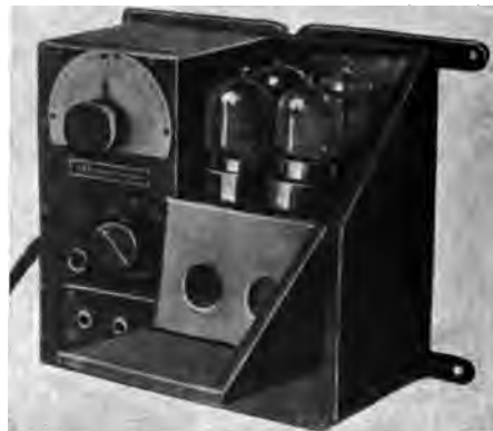
Abb. 159. Telefunken-Audion-Empfänger mit eingebautem 3 Röhren-Verstärker.
