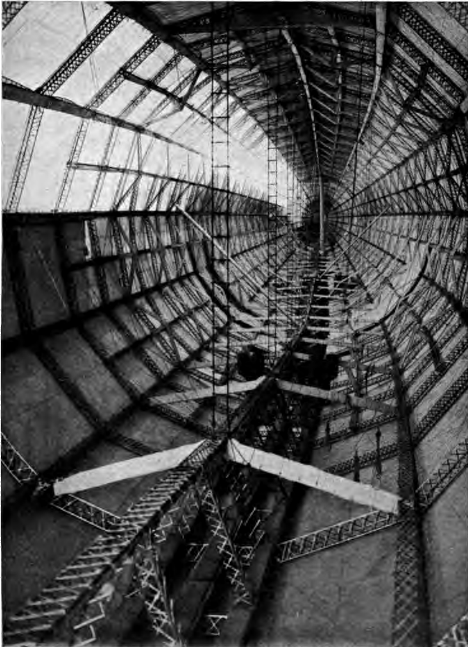
Abb. 22. Marineluftschiff L. 30. Längsblick in das Innere vor dem Einbringen der Gaszellen; Gerippe fertig; unten der sich über die ganze Länge erstreckende Laufgang.
