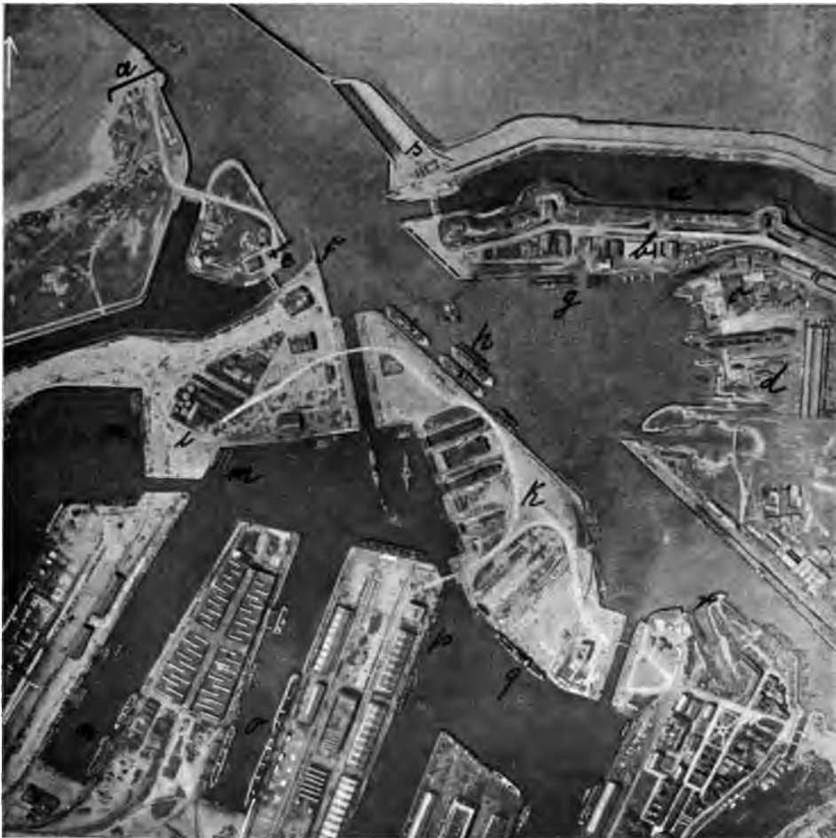
Abb. 145. Dünkirchen, Hafengebiet (Juni 1917), Brennweite 50 cm; Flughöhe 5000 m. Bei a und a' Küstenbatterien, bei a' mit Lupe 2 Geschütze erkennbar, b französische Wasserflugstation mit 3 Flugzeugen davor, c englische Wasserflugstation: Riesenhalle mit Ablaufbahn, d die Werft: ein 8000 t-Dampfer auf der Helling, e Leuchtturm, f F. L.-Station, g 2 Zerfänger und 5 Torpedoboote, h 3 Monitore, i Gasanstalt, k Docks, m Leichter, n kleinere Fahrzeuge, o 3 größere Transportdampfer, p kleinere und q mittlere Frachtdampfer, r kleine Werft, s Rettungsstation.
