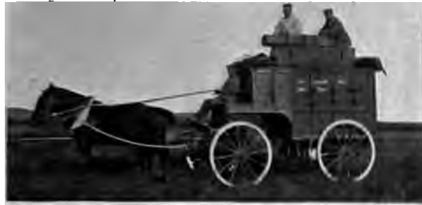
Abb. 125. Dach und kleiner Raum hinter dem Fahrerflur zur Unterbringung der Kammern. Hier auch Wasserbehälter eingebaut. Für Beleuchtung Akkumulatoren und ein Farfenster an der Rückseite des Wagens.
