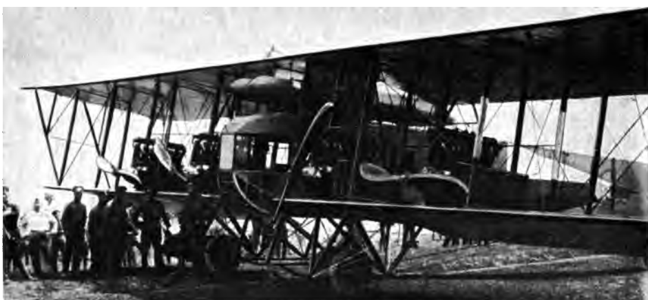
Abb. 80. Dasselbe in Vorderansicht. Vorderer Rumpfteil als geschlossene Kabine gebaut. Auf Tragflächen 4 Motoren mit Zugschrauben. Über der Kabine Benzintanks. Flog mit 7 Mann Besatzung.
