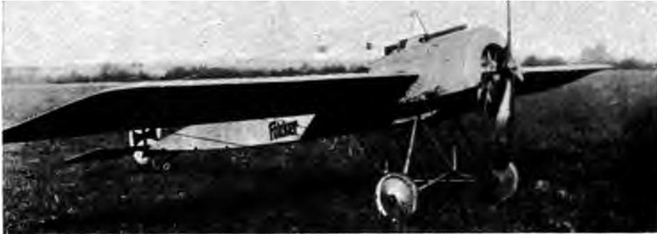
Abb. 65. Fokker E I/1915 (s. Tab. II, Nr. 38). Das erste deutsche Jagdflugzeug mit auf dem Bild gut erkennbarem, im Spannturm liegendem, motorgesteuertem, star eingebaurem M. G. Zahlreiche obere und untere Verpannungsbräfte (vgl. Abb. 71/72 und 64). Umlaufmotor. Das erste Flugzeug Voeldes für den Luftkampf.
