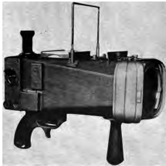
Abb. 124. Fliegerkammer 9 \times 12 mit 25 cm Brennweite. Objektiv ist durch drehbare Klappen geschützt. Verschlußauslöser befindet sich im Pistolengriff.
