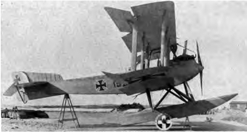
Abb. 96. Seefähiges Friedrichshafener Aufklärungsflugzeug mit 200 P.S.-Benzmotor.
