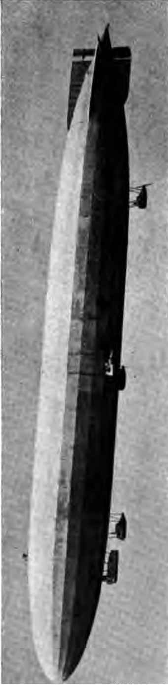
Abb. 11. S. L. S. L = 174 m, D = 20,10 m, Gasraum = 38 700 cbm, Geschwindigkeit = 25,8 m/sec. Gondelanordnung wie bei L. 43, vordere Führer- und Motorengondel aber getrennt voneinander.
