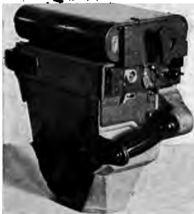
Abb. 135. Rollfilmkamera. Auf die normale Kammer 13 \times 18 mit 25 cm Brennweite ist eine Rollfilmkassette angepaßt. Durch Drehung des dreieckigen Knopfes wird der Film transportiert und gleichzeitig der Verschuß gespannt.
