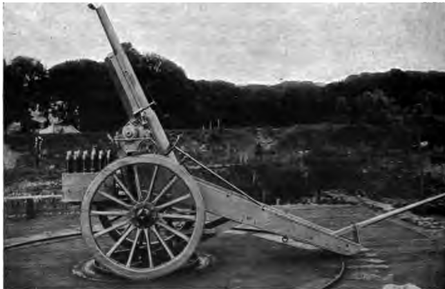
Abb. 203. Deutsches 7,7 cm-Feldgeschütz behelfsmäßig als Flak. Abb. 204. Früheres deutsches Feldgeschütz (9 cm) behelfsmäßig als Flak im sogenannten Schneker-Sattel. Abb. 205. Russisches Beutegeschütz (7,62 cm) als ortsfester Flak in den Dünen bei Ostende. Abb. 206. Französisches Beutegeschütz (7,5 cm) als Flak.
