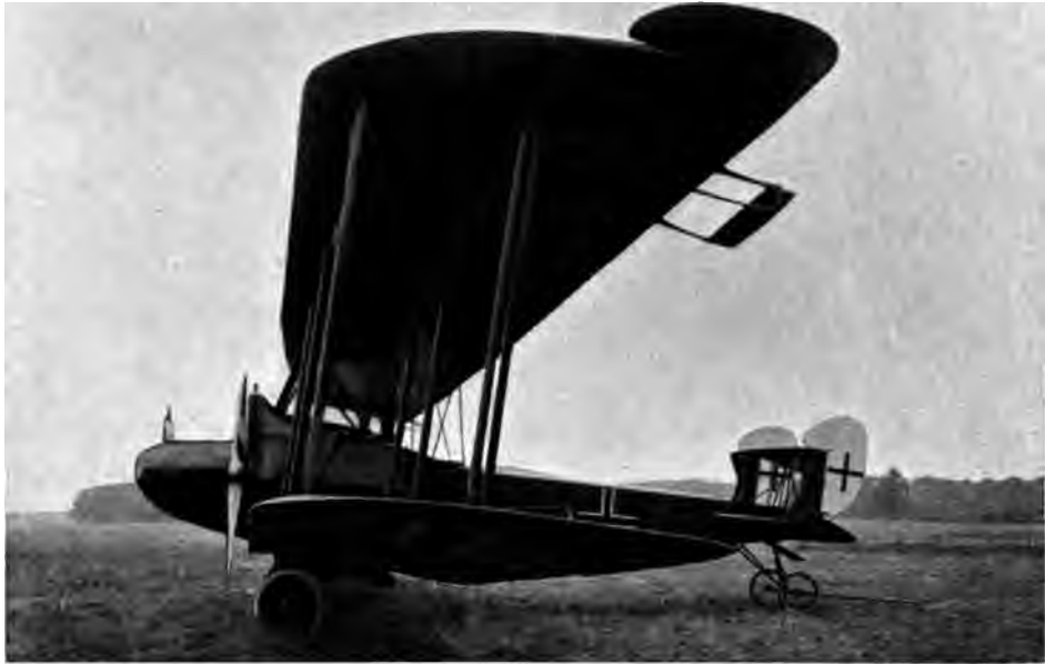
Abb. 75. AEG GV (s. Tab. III, Nr. 44). Besonders großer Tragflächenabstand. Verwindungsflappen sind durch negativ gewölbte Zusatzflächen ausbalanciert, um Steuerdruck zu vermindern. Kleines Fahrgestell unter Schwanz für Landtransport.
