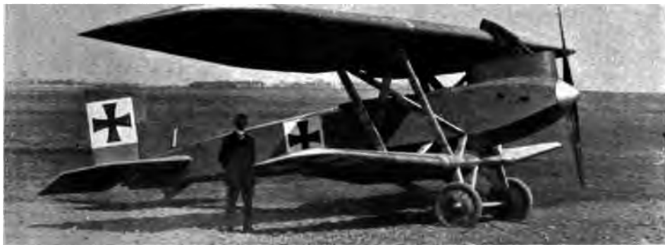
Abb. 60. Junkers-Fotler J I (s. Tab. I, Nr. 23). Verspannungsloses Ganzmetallflugzeug. Motor im Panzerschutz einbegriffen. Ungewohnt dickes Tragdeckprofil erkennbar.
