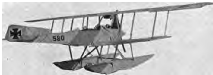
Abb. 95. Sablatnik-Aufklärungsflugzeug mit 160 P. S.-Mercedes.
