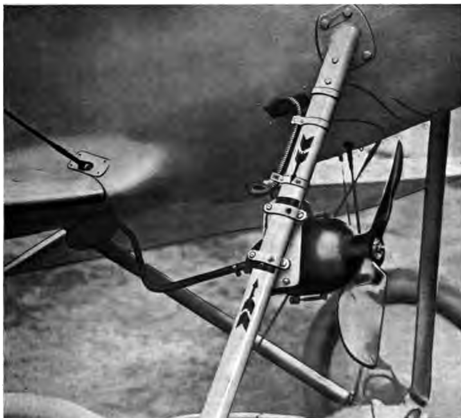
Abb. 151. F. T.-Generator Type C (Telefunken) mit Luftschraube am Fahrgerüst des Roland C II.
