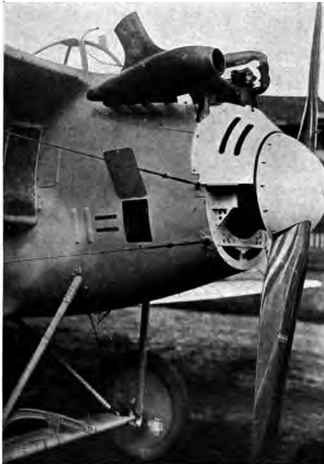
Abb. 55. Rumpfvorderteil des LFG C II mit Motoreinbau, Auspufftopf (tropfenförmig), Propellerhaube, Ohrentühlern, Spannriemen. Achse mit Verkleidung in tropfenförmigem Querschnitt.
