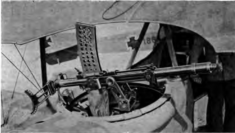
Abb. 193. 2 cm-Flugzeugkanone im Beobachteritz eines Seekampf-Flugzeuges.
