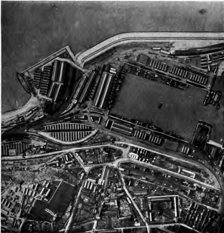
Abb. 144. Boulogne sur Mer, Bassin Loubet (April 1916). Bei a 5 groe und 3 mittlere Frachtdampfer, bei b 3 Bagger. Hafenbassin umsumt von groen Gterhallen und Schuppen; zwischen ihnen Gleise. Gterstapel bei e. Auf sudlichem Quai mit Lupe die eisernen Gittertrger der Ladetrane erkennbar. c Wasserflugstation, d Wasserturm, f Anfang des groen Barackenlagers von Capecure, g Arsenal.
