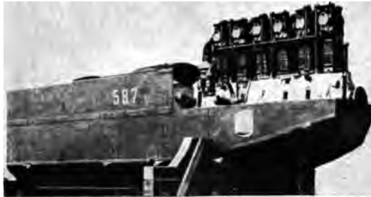
Abb. 61. Panzerschutz des Junkers-Fokker J1 (s. Abb. 60) aus 5 mm Chromnickelstahl.
