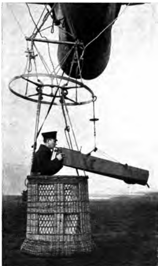
Abb. 140. Verbesserte Aufhängung für Ballonkammern. Der Ring ist der veränderten Ballon- und Korbbaukonstruktion angepaßt. Länge des vertikalen Seiles verstellbar. Kammer bleibt außerhalb des Korbes; wird nur zur Aufnahme hereingetippt.
