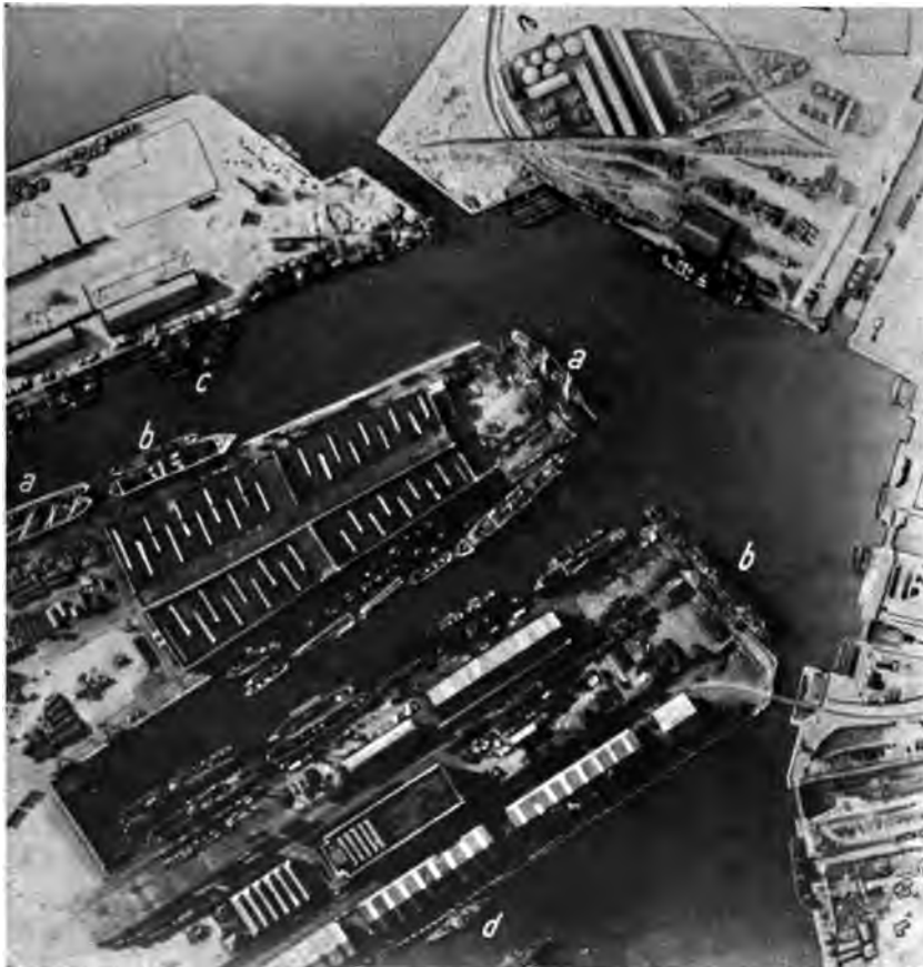
Abb. 142. Dünkirchen Hafengebiet (April 1916) Brennweite 50 cm; Flughöhe 3800 m. — Große Güterschuppen mit Gleisen, Wagen und Güterstapel. Bei a Segelschiffe, Masten und Rahen deutlich erkennbar. b Fracht- und Transportdampfer, c Torpedoboote, d Raddampfer, e Gasanstalt.
