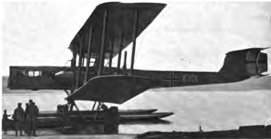
Abb. 107. Riesen-(R-) Seeflugzeug der Zeppelinwerke Staaten mit vier 260 P. S.- Mercedesmotoren. Leergewicht 9000 kg, Nutzlast 3500 kg. Stieg 1000 m in 13 Min., 2000 m in 29 Min., 3000 m in 54 Min.
