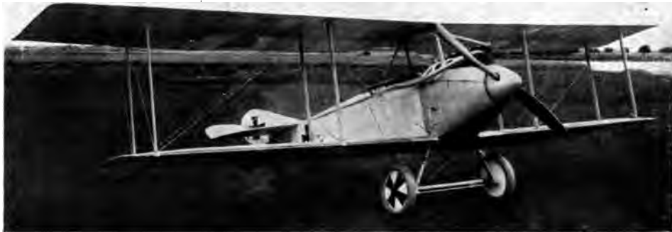
Abb. 51. Aviatik C III/1915 (f. Tab. I, Nr. 5). Für damalige Zeit sehr schnell; günstige Torpedokörperform; Tragflächenkühler an Mitte Unterseite oberen Tragdecks. M. G.-Anordnung mittels Gleitschiene zu beiden Seiten des Rumpfes. Beobachter vorn. Geschickte Verspannung des Innenfeldes gab gutes Schußfeld (Kreuzlabel ohne Stirnlabel, Anschluß der Standlabel am oberen Rumpfhorn).
