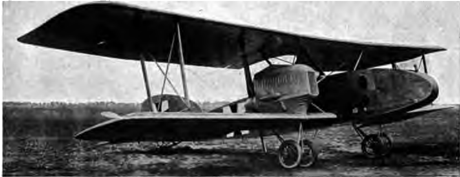
Abb. 73. Albatros G III (s. Tab. III, Nr. 42). Rechts und links vom Rumpf je ein Stahlrohrstielpaar. Strömklärer. Oben und unten geteilte Flügel. 3 Sitze hintereinander; Führer inmitten.
