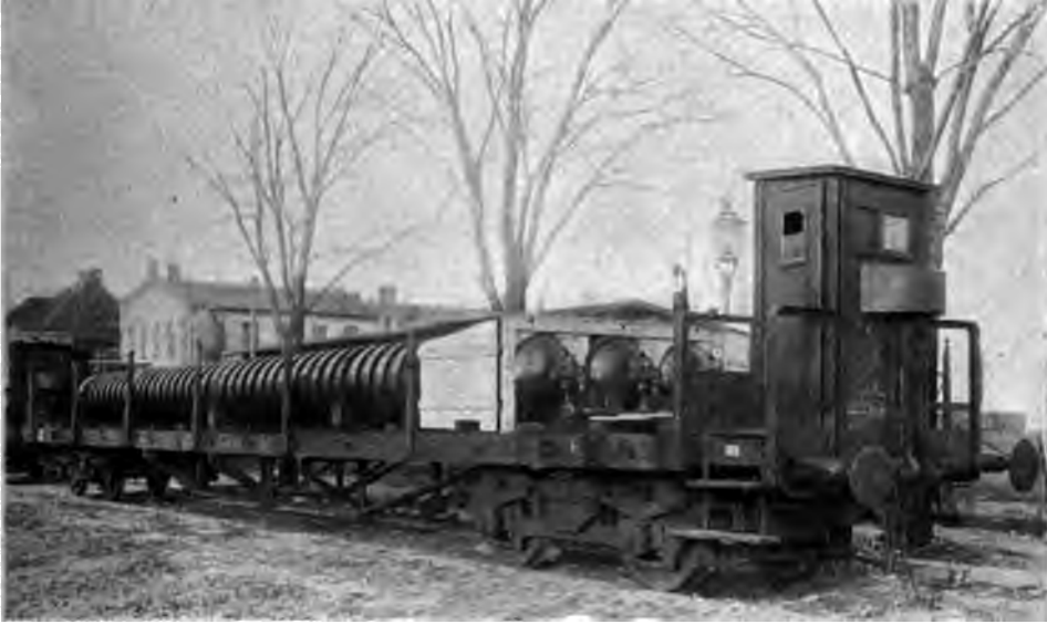
Abb. 43. Erster, von der Bamaq-Berlin gebauter Marinegaszylinderwagentyp. Drei Bandagenkessel von je 12,5 m Länge, 720 mm innerem Durchmesser und 517 cbm Gasinhalt bei 100 Atm. Druck; Gesamtinhalt der Gaszylinder 1551 cbm; von rechts der Bedienungsraum.
