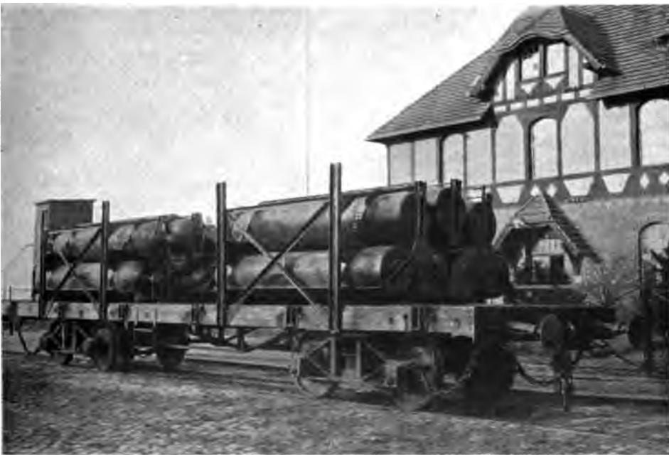
Abb. 44. Neuester Marinegaszylinderwagentyp (Dach und Seitenwände noch nicht eingebaut). Zwei Gruppen von je sieben übereinanderliegenden Gaszylinder von 3,85 m Länge, 585 mm innerem Durchmesser und je 184 cbm Gasinhalt bei 200 Atm. Druck, Gesamtinhalt aller Kessel 2576 cbm. An dem Kopf der linken Kesselgruppe die Gasabfüllventile und -leitungen; die Kessel selbst sind durch schwere Trägerarmierungen und nachziehbare Eisenbänder fest auf dem Wagen gelagert und gegen Verschieben während des Transportes gesichert.
