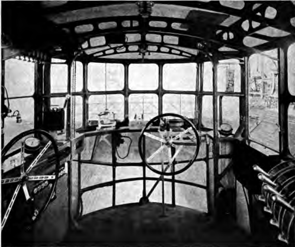
Abb. 32. Innenansicht (Blick nach vorn) der Führergondel des S. L. 14. Links vorn Höhensteuerrad, dahinter und darüber verschiedene Fahrinstrumente, Barographen usw.; rechts darunter elektrische Schalter; darüber an der Decke Büge für Wasserballastabgabe; in der Mitte Seitensteuerrad; davor Kompaß; rechts davon Kettenübertragung zu den im Laufgang liegenden Steuerzügen; links vom Seitensteuer elektrischer Bombenabwurfapparat und Zielfernrohr; ganz rechts elektrische Maschinentelegraphen; in den Gondelwänden Cellonscheiben oder Triplexglas.
