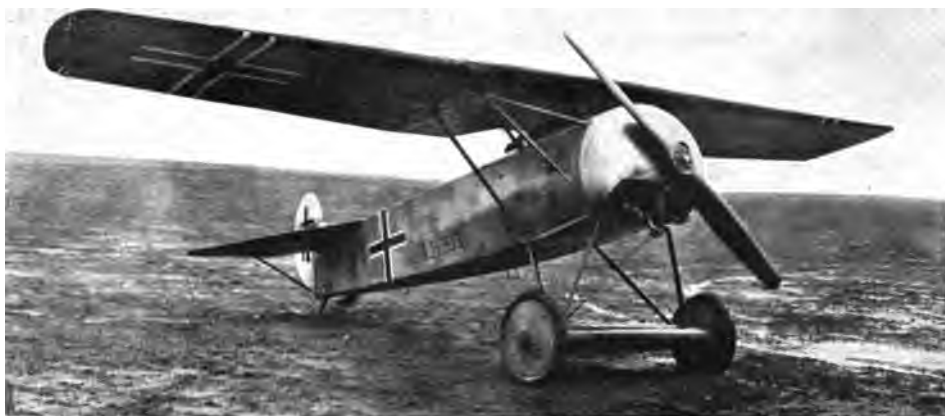
Abb. 71. Fokker D VIII (s. Tab. II, Nr. 38). Spannungsloser Hochdecker mit Umlaufmotor. Benzintank abseits des Rumpfes in Höhe der Achse zwischen den Rädern, um beim Luftkampf die Brandgefahr zu verringern.
