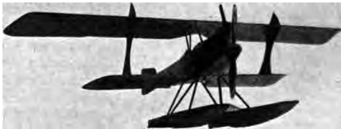
2166. 98. Sablatnik-Seeampfeinfiger mit 150 P. S.-Benzmotor.
