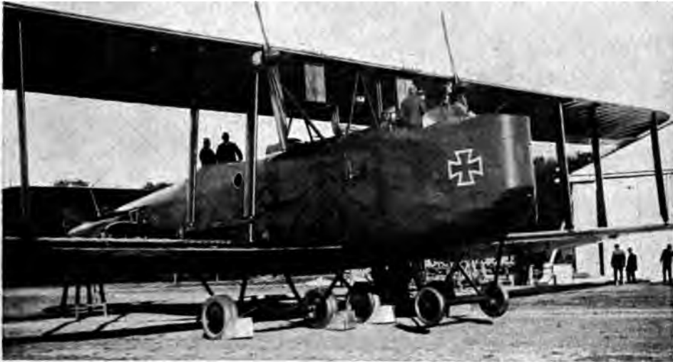
Abb. 88. D.F.W. R1 (s. Tab. III, Nr. 50). Holzrumpf, mit einer Haut aus mehrfachem, wasserfest verleimtem Sperrholz umzogen, enthält zwischen den Flügeln in einem geschlossenen Gestühl aus gepreßtem Stahlblech vier 260 P.S.-Mercedesmotore, je zwei auf jeder Rumpfsseite übereinander. Die beiden unteren Motore treiben durch Querwelle mit Regelradgetriebe und mit Untersehung von 14:9 die am Hinterholm des Unterdecks gelagerten zwei Druckpropeller mit 900 Touren; die zwei oberen Motoren entsprechend die beiden vorderen Propeller am Vorderholm des Oberdecks. Motor- und Propellerwellen arbeiten also parallel. Die Propellerströme berühren sich nicht, was den Wirkungsgrad begünstigt. Mit nur zwei der Motoren ist Geradeausfliegen noch möglich. Das vordere, leichtere Fahrgerüst dient dazu, die Maschine bei schwierigen Landungen vorn abzufangen. Im Innern des Rumpfes freier Durchgang zwischen den beiden Motorengruppen.
