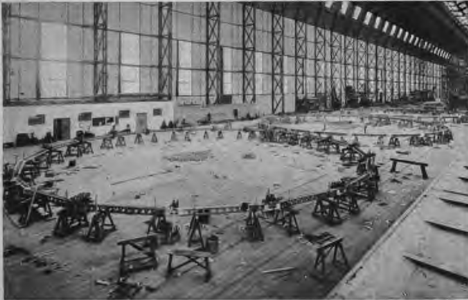
Abb. 26. Bau der Ringe eines Schütte-Lanz. Sie werden auf Böden in horizontaler Lage zusammengebaut, verspannt und mit besonderen Hilfseinrichtungen aufgerichtet. Im Hintergrund rechts der bereits stehende Teil des Schiffskörpers.
