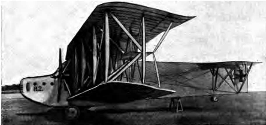
Abb. 83. Siemens-Schudert R II (s. Tab. III, Nr. 55). Maschinen-, Getriebe- und Schraubenanlage wie bei R I. Schrauben laufen zugunsten des Wirkungsrades langsamer. Drei 260 P. S.-Mercedes. Zwei nebeneinandergelegene Führerfische über dem Zentralgetriebe, gegen Wind und Wetter geschützt, mit freier Aussicht nach allen Seiten. Darvor, dahinter, darüber und darunter die M. G. Im Rumpfunterteil die Bombenabwurfvorrichtungen. Starke Verstrebungen der Tragbeds. Einfaches Fahrgerstell wie beim R I.
