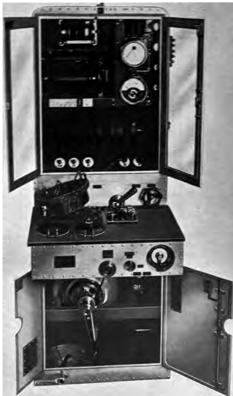
2166. 147. Luftschiff-F. L.-Station älterer Bauart (Telefunken).
