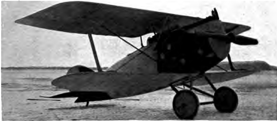
Abb. 67. Rumpler D I (s. Tab. II, Nr. 33). Einstieler mit eigenartiger Verspannung. Kurzer, hoher Rumpf. Rechtes Motor-M. G. erkennbar.
