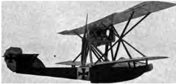
Abb. 103. Hansa-Brandenburg-Einflieger-Kampfflugboot mit 150 P.S.-Benzmotor.
