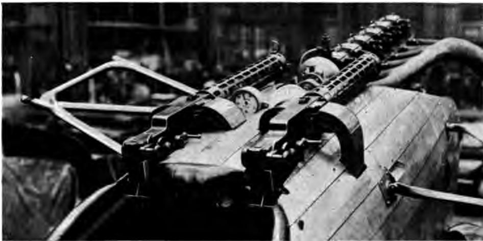
Abb. 188. M. G.-Einbau LFG D VI (Abb. 66) Schußrichtung rechts und links neben der Krankenwelle des Mercedes vorbei.
