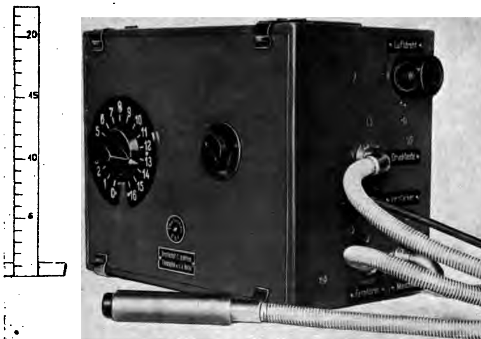
Abb. 157. Sender-Empfänger, Type A, für Kampfeinsitzer mit Zwischenhöreinrichtung und Taste.
