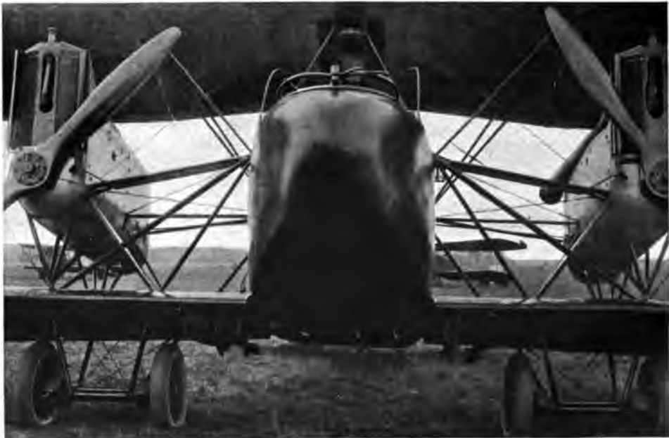
Abb. 76. Motorenanlage und Fahrgestell des AEG GIV (s. Tab. III, Nr. 43). Stierntübler. Doppeltes Fahrgestell mit Achsenabfederung. Unter Rumpf leere, unter Tragflächen gefüllte Bombenaufhängung. Zugpropeller.
