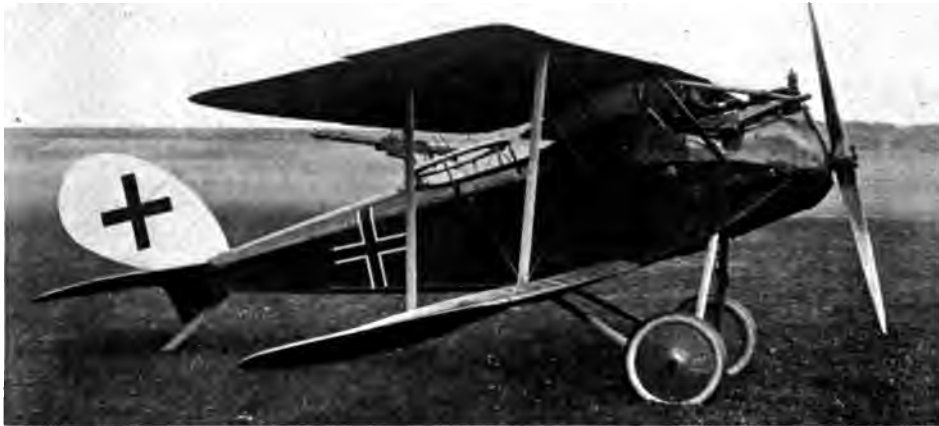
Abb. 62. Halberstadt CL IV (s. Tab. I, Nr. 8). Einsteiler mit 2 Verspannungsebenen. M. G. im Beobachteritz besonders deutlich, ebenso die gedrungene, kurze und leichte Bauart dieses Schlachtflugzeuges.
