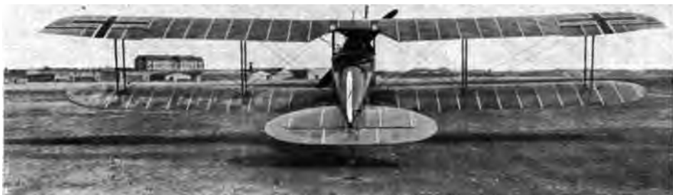
Abb. 53. LVG C VI (f. Tab. I, Nr. 14). Zwei Verspannungsebenen, vgl. in Abb. 63: dort nur eine Verspannungsebene beim späteren Einsteiler und Abb. 69/70 ohne jede Verspannung.
