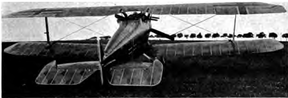
Abb. 63. Hannover CL V (s. Tab. I, Nr. 11). Einsteiler mit einer Verspannungsebene. Sehr hochgezogener Fournierhautrumpf. Sitz und Schußfeld über oberes Tragged.
