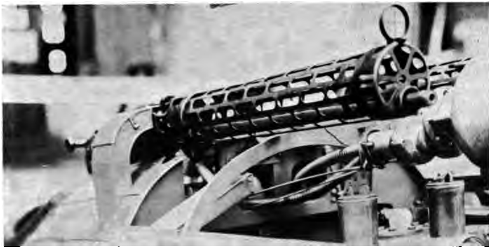
Abb. 189. Dasselbe von vorn. Man sieht die von den Nebenantriebswellen des Motors zum Anschluß an die M. G.-Steuerungen führenden beiden biegsamen Kupplungswellen. Diese Wellen werden auf kürzestem Wege mit möglichst geringer Biegung zum M. G. geführt und seitlich oder von unten dem Abzug entsprechend angeschlossen. Für jedes M. G. wurde am Getriebe eine Antriebswelle verwendet. Der Anschluß der Getriebe am Motor war dem jeweiligen Motortyp angepaßt. Der Anschluß der Nebenantriebswellen war der normalisierte Tachometeranschluß. Die Nebenantriebswellen wurden, je nach dem Motortyp und je nach- dem, ob M. G. oder Tachometer mittels der Kupplungswelle angeschlossen werden sollten, mit gleicher, übersehener bzw. untersehener Umdrehungszahl in Bewegung gesetzt.
