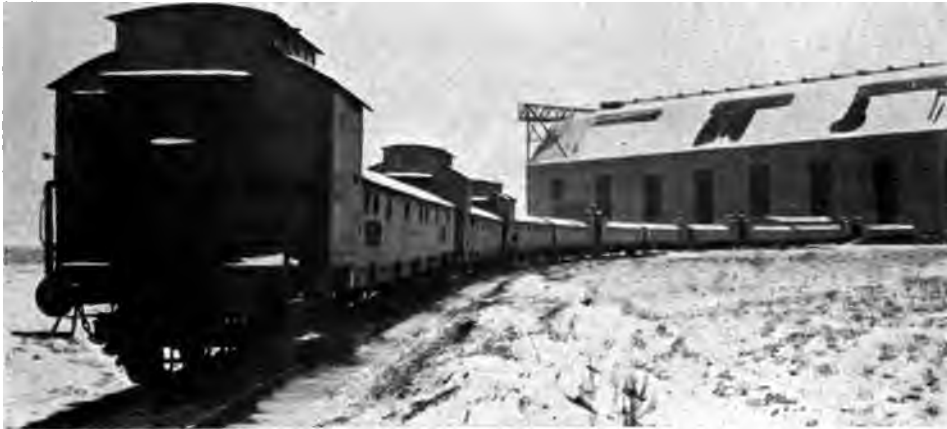
Abb. 45. In einen Eisenbahnzug zusammengestellte Gaskesselwagen (Frank-Bremen). Gesamt-beförderungsmenge 19200 cbm (hierfür sonst mindestens 3200 kleine Gasflaschen erforderlich). Auf jedem Wagen zwei Kessel von 15,5 m Länge und zusammen 1920 cbm Gasinhalt bei 100 Atm. Druck. An einem Ende des Wagens der Bedienungsraum.
