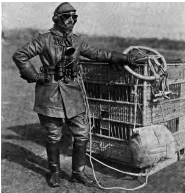
Abb. 168. Ballonbeobachter mit Kopffernhörer am Ohr und Schalltrichter auf der Brust. Unten rechts der zusammengerollte Fallschirm. Der Beobachter in Sommerausrüstung.
