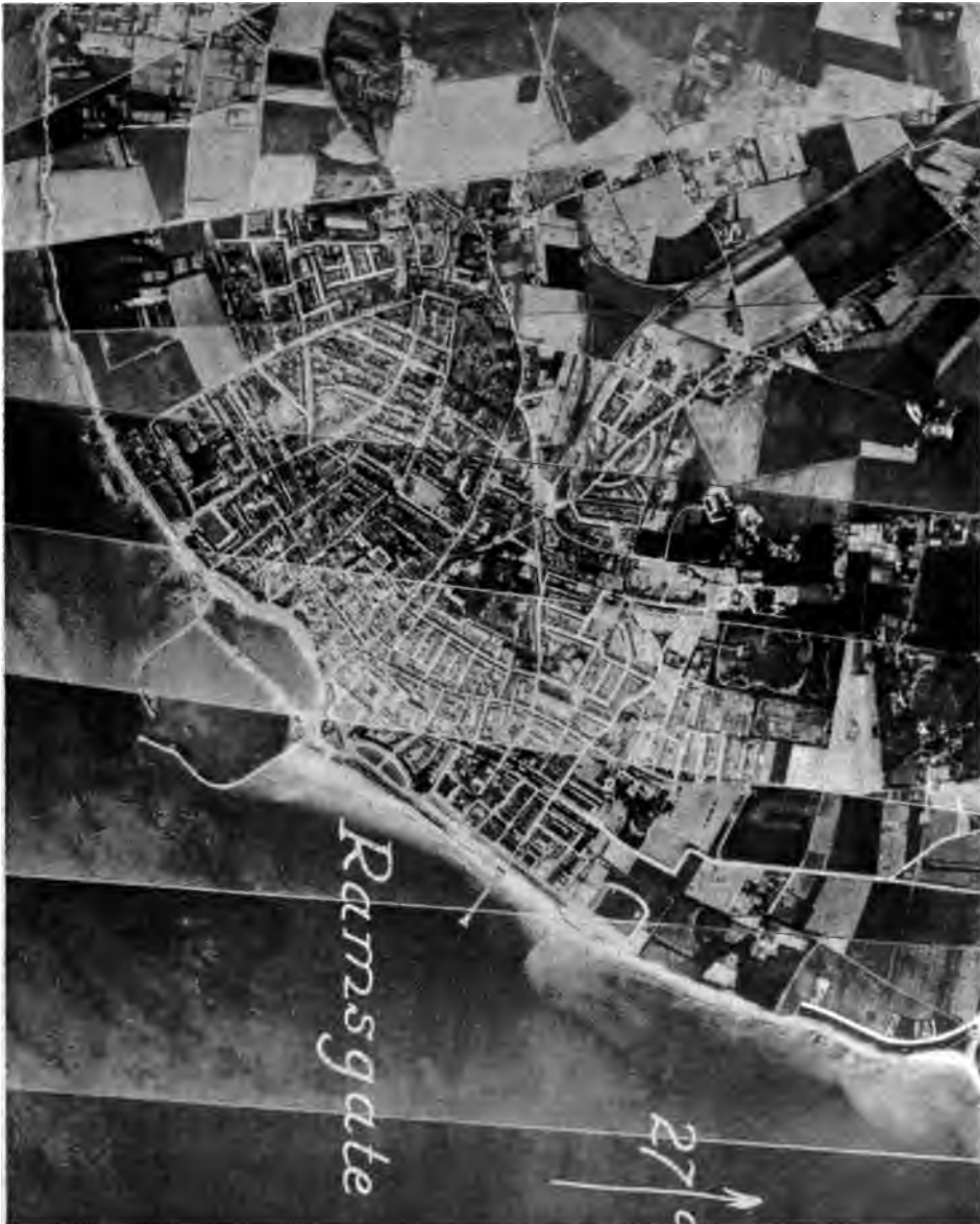
Abb. 133. Teil eines Reihenbildfluges über England. 6000 m Höhe; 25 cm Brennweite. Küstenstadt Ramsgate mit Hafen, darin einzelne Schiffe. Die Streifen sind die aufeinanderfolgenden Aufnahmen, die zusammengesetzt und einheitlich kopiert werden.
