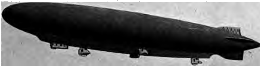
Abb. 13. P.L. 27. L=157 m, D=18,6 m, Gasraum=31 150 cbm, Geschwindigkeit = 25 m/sec. Modernes Prallschiff; unter Schiffskörper außen liegender Laufgang; unter diesem vorn Führergondel; dahinter etwas tiefer vordere Motorgondel; dahinter zwei seitliche Einmotorgondeln; achtern eine Einmotorgondel; auf dem Schiffsrücken vorn und achtern je eine Plattform.
