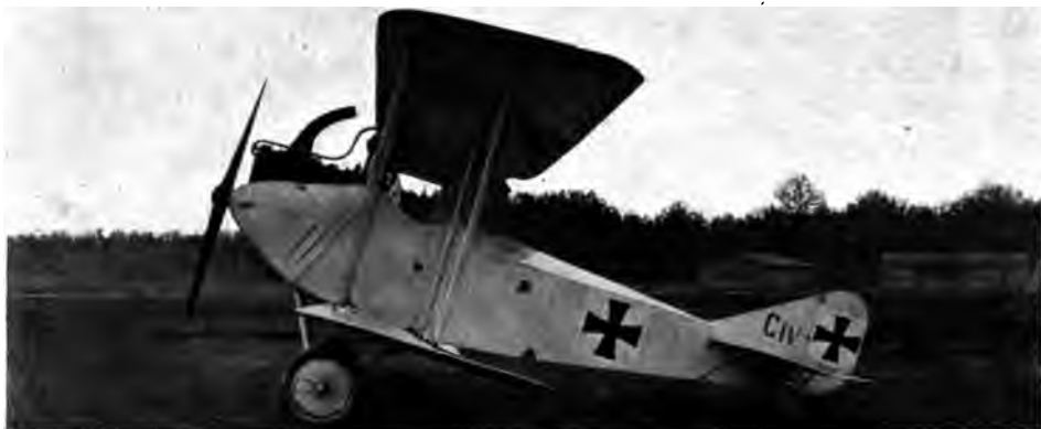
Abb. 52. AEG C IV (f. Tab. I, Nr. 4). Im Beobachteritz (hinten) Träger für auf Drehtrans schwenkbares M. G. Auspuffstutzen bläst über oberes Tragdeck ab.
