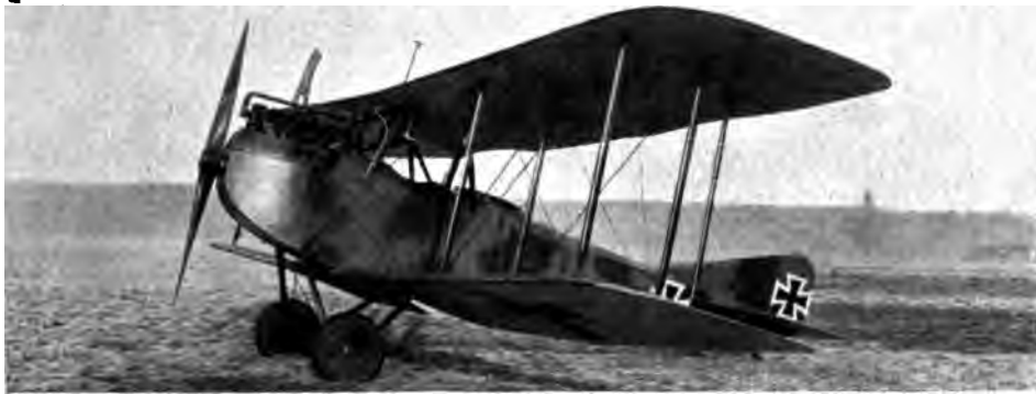
Abb. 59. AEG J II 1917 (s. Tab. I, Nr. 22). Die starke kreuzweise Drahtverspannung ein Zeichen noch älterer Bauart. Auch hier der Panzerschutz erkennbar.
