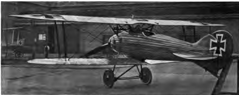
Abb. 66. LFG DVI (s. Tab. II, Nr. 31). Rumpf in Klinterbauart (fester, leichter und reparaturfähiger als der Wickelrumpf); verspannungslose Dämpfungsfächen, unterer Spannrücken (trotz des großen Flügelabstandes Oberflügel fast in Augeshöhe des Führers), gutes Gesichtsfeld, niederer Rumpfsquerschnitt.
