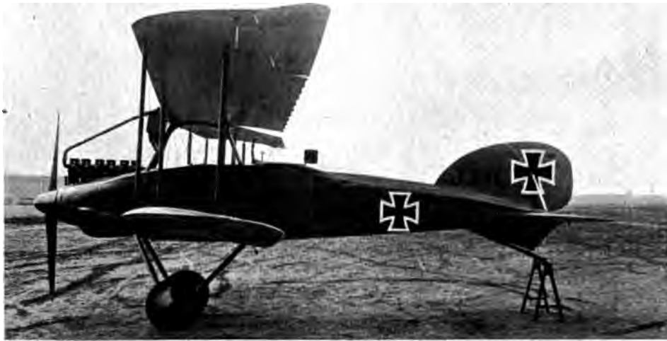
Abb. 58. Albatros JI (s. Tab. I, Nr. 19). Deutlich erkennbar der von Propellernabe bis einschl. Beobachtersitz reichende Panzerschutz.
