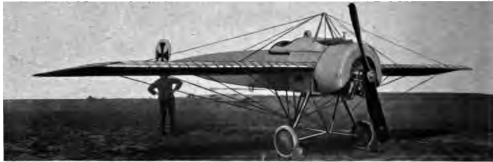
Abb. 192. Fokker E IV mit 3 starren, motorgesteuerten M. G.
