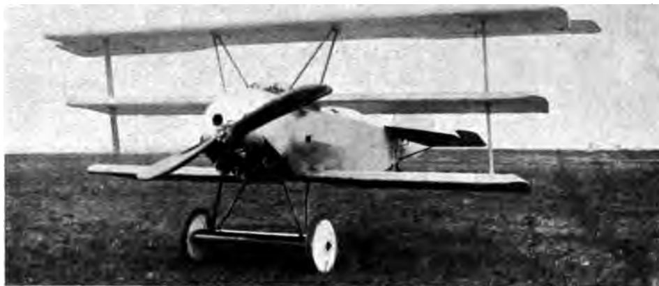
Abb. 70. Fokker Dr I (s. Tab. II, Nr. 37). Gleichfalls spannungslos. Umlaufmotor. M. G. ragen über die Haube.
