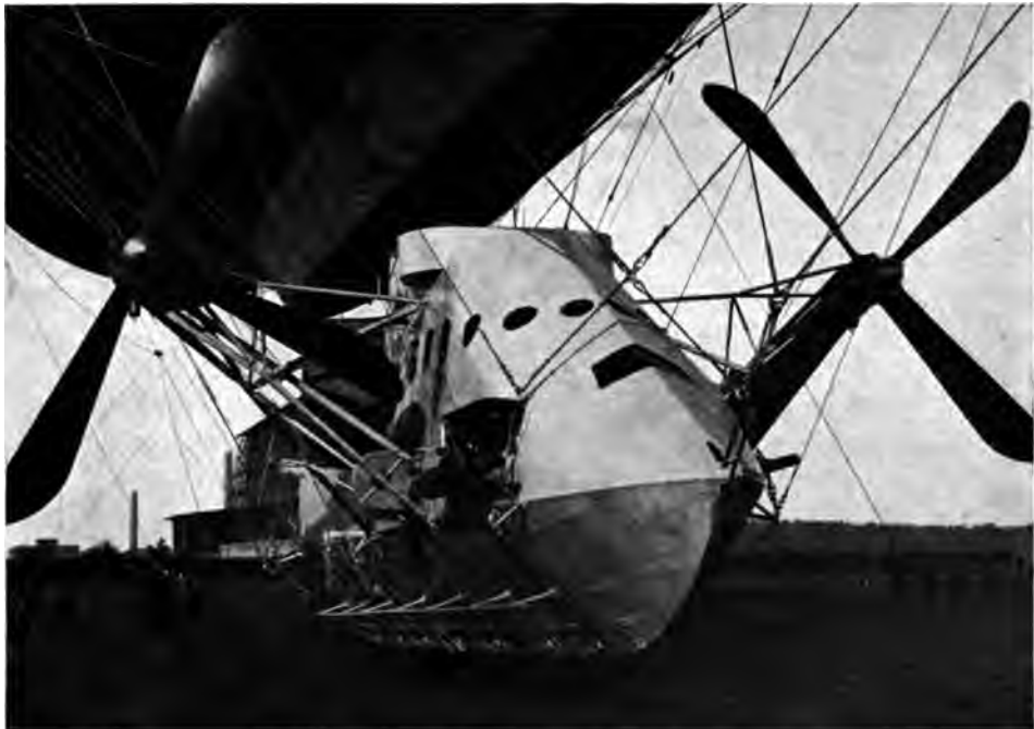
Abb. 14. Ansicht von vorn auf die Gondel des P.L. 19 mit seitlichen Propellerböden; über der Gondel unter dem Schiffe kurzer Laufgang.
