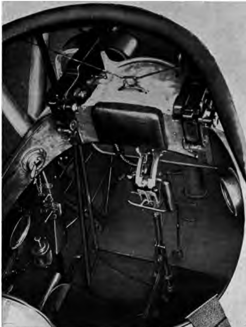
Abb. 191. Steuer säule, Abzugsvorrichtung und Verschlussstück der beiden starren M. G. beim Siemens-Schudert D IV.
