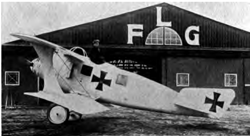
Abb. 54. LFG C II (s. Tab. I, Nr. 13), genannt „Walflisch“ (1915/16) 1. Flugzeug mit tropfenförmigem Rumpf in Stromlinienform. Luftwiderstand auf geringstes Maß beschränkt. Eng anliegende Ohrentübler, Flächenstiel: höhere Festigkeit, geringeres Gewicht, günstiger Luftabfluß. — Tragdeckabstand gleich Rumpfhöhe: freies Sicht- und Schußfeld über oberes Tragdeck. Gewinkelte Rumpfhaut. Im Rumpf Fenster.
