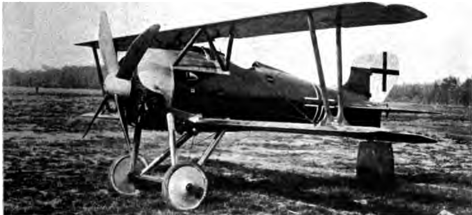
Abb. 68. Siemens-Schudert D IV (s. Tab. II, Nr. 35). M. G., vierflügelige Schraube und Umlaufmotor in Haube gut erkennbar. Beide M. G. zu sehen.
