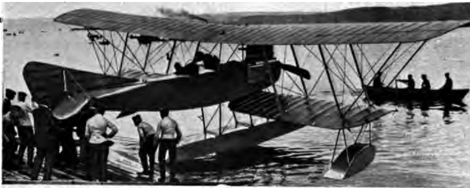
Abb. 92. Beginn des deutschen Seeflugzeugbaues. Friedrichshafen-Flugzeug mit Mittelschwimmer und 110 P.S.-Argusmotor.
