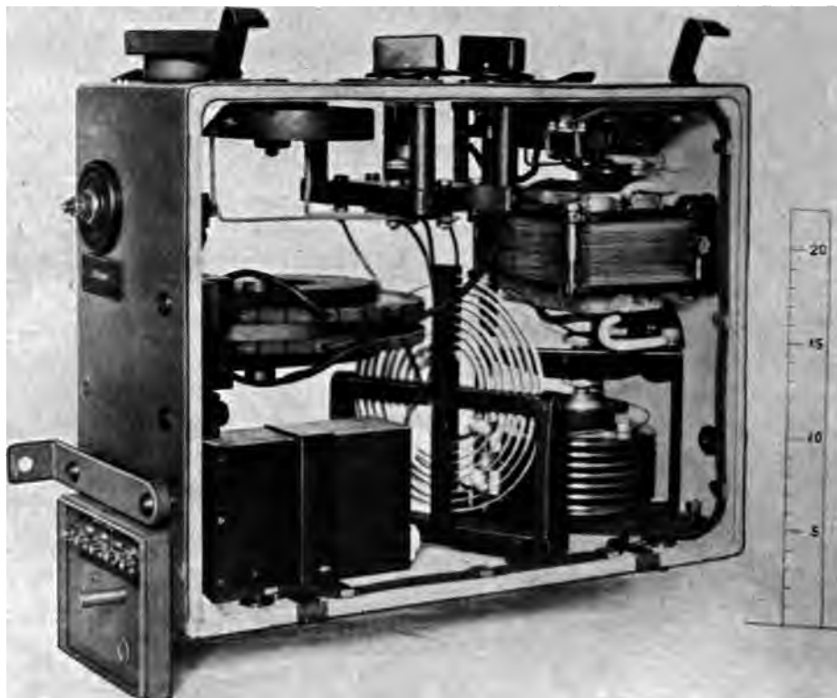
Abb. 150. Kleiner Flugzeugsender für C-Flugzeuge, Wellen 150, 200, 250 m (Telefunken).
