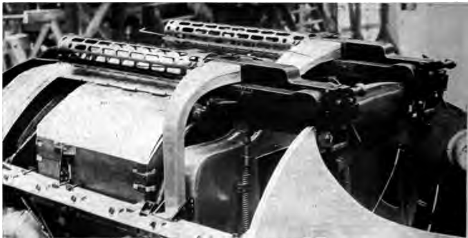
Abb. 190. Einbau der M. G. beim Siemens-Schuckert D IV (Abb. 68). Man sieht den Anschluß der vom Umlaufmotor herführenden biegsamen Kupplungswellen an dem Abzug jedes der M. G.
