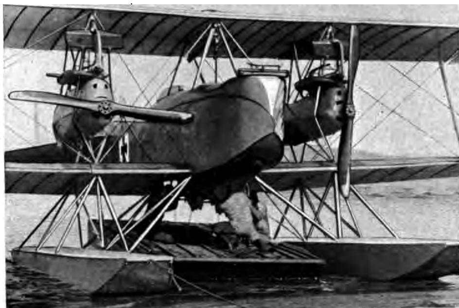
Abb. 109. Anbringen eines Torpedos unter dem Rumpf eines T-Flugzeuges.
