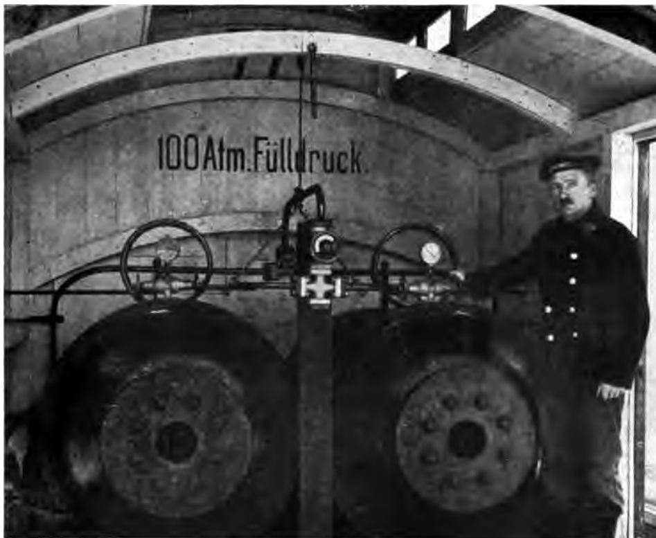
Abb. 46. Inneres des Abfüllraumes eines der vorstehenden Wagen. Blick auf die Köpfe der Gaskessel und die Abfüllarmaturen.
