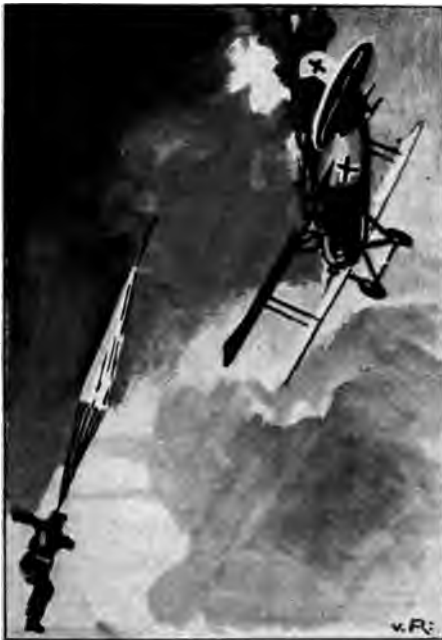
Abb. 177. Das Zugseil reißt an der Reißschnur ab und der Schirm beginnt die Entfaltung.
