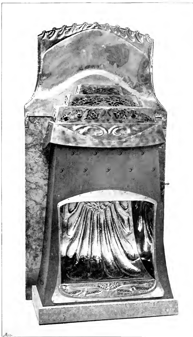
B. PANKOK • GASKAMIN • AUSGEFÜHRT VON DEN VEREIN. WERKSTÄTTEN BLENDE, AUFSATZ UND OBERES RÜCKENTEIL IN KUPFER GETRIEBEN UND AUSGESAGT; MANTEL IN SCHMIEDEEISEN; SOCKEL UND RÜCKWAND IN MARMOR (SYSTEM J. G. HOUBEN & SOHN CARL, AACHEN)
