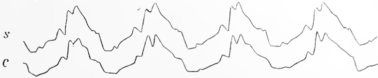
Fig. 73. Prüfung der Registriertrommel Mareys . Nach Donders . S, die Führungskurve; C, die registrierte Kurve.
