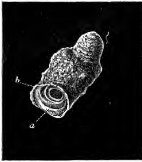
Fig. 8. Natürliche Grösse. Ein Stück Senegalgummi, quer gebrochen. a Bruchfläche, glänzend homogen. b rissige, das ganze Stück umkleidende Hülle.
