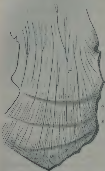
Fig. 9. Vergrößerung 40 mal. Bruchfläche von einem Stück arabischen Gummi. Die Risslinien rr stehen genau oder nahezu senkrecht auf den Zonen ( z ) der Muschelbruchfläche. Nach links ist die Fläche unbegrenzt.
