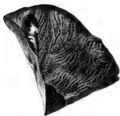
Fig. 14. Vergrößerung 1\frac{1}{2} . Unregelmässige Rissbildung an der Oberfläche von im Wasser unvollkommen löslichem, zähem Acaciengummi.
