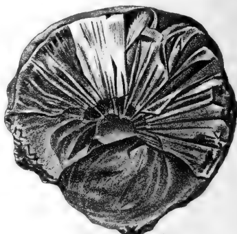
Fig. 15. Vergrößerung 2. Bruchfläche eines Gummistückes einer Sorte von Somaligummi mit strahlendem Gefüge. (Aus der Sammlung des bot. Museums in Berlin.)
