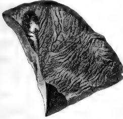
Fig. 5. Vergrößerung 1\frac{1}{2} mal. Unregelmässige Rissbildung an der Oberfläche von im Wasser unvollkommen löslichem, zähem Acaciengummi.
