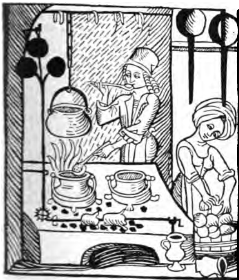
Abb. 100. Bratenwender mit Schwungkugeln, 1507.
