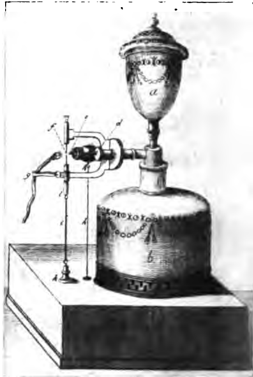
Abb. 211. Elektrisches Feuerzeug, nach Journal des Luxus, 1800.
