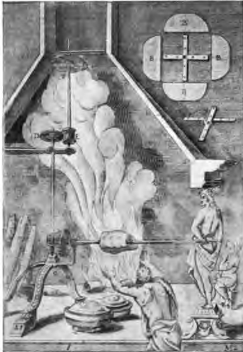
Abb. 101. Bratenwender mit Warmluftbetrieb. 1607.
