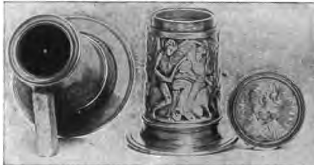
Abb. 498. Nadelniveau, um 1560. Links das umgelegte Instrument. In der Mitte das aufrecht stehende Instrument. Rechts der Deckel desselben. Mathematisch-physikalischer Salon Dresden.
