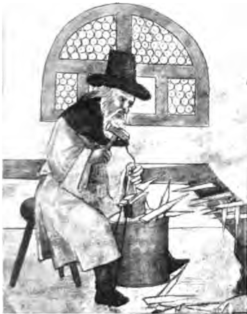
Abb. 197. Feilenhauer, Nürnberg 1534; er haut mit Meißel und Hammer.
