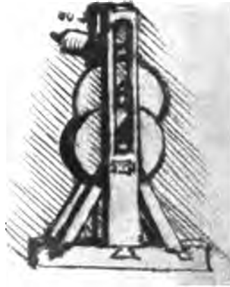
Abb. 411. Lagerbock für eine Achse, die auf 2 Rollen läuft, nach Leonardo, 1496.
