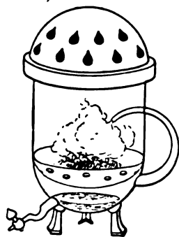
Abb. 124. Dampfgebläse nach Philon (Ausgabe von Carra de Vaux).
