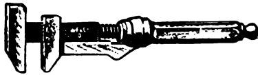
Abb. 654. Moderner verstellbarer Schraubenschlüssel. Die Verstellung geschieht mittels Schraube durch Drehung des Griffes.
