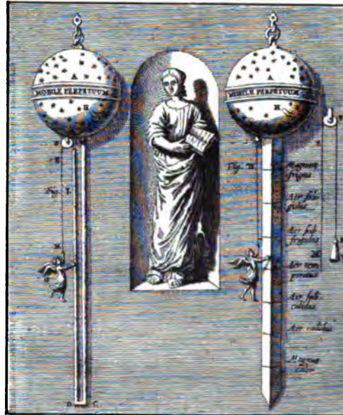
Abb. 753. Weingeistthermometer von Guericke, um 1658.
