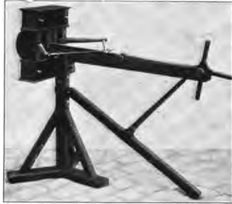
Abb. 250. Keilspanner, nach Philon rekonstruiert. Aus: Schramm, Bemerkungen zu der Rekonstruktion griechisch-römischer Geschütze, herausgegeben von der Gesellschaft für lothringische Geschichte und Altertumskunde in Metz, die auch die Klischees 250—252 u. 255 zur Verfügung stellte.
