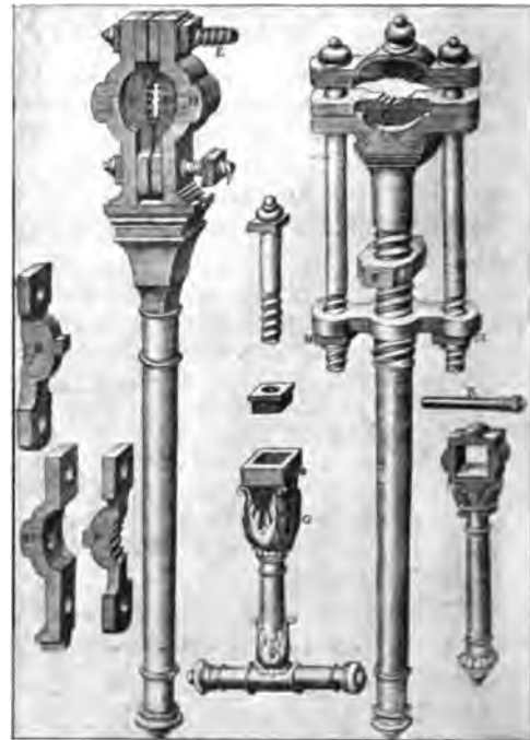
Abb. 221. Zwei verschiedene Fräser und deren Einzelteile, nach Ramelli 1588.
