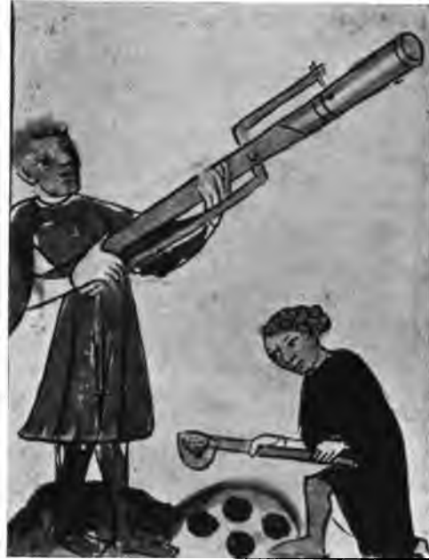
Abb. 296. Stangenbüchse mit langem Hebel für die Lunte, unten ein Mann, der Kugeln gießt. Aus Cod. 3069 der Wiener Hofbibliothek, von 1411.
