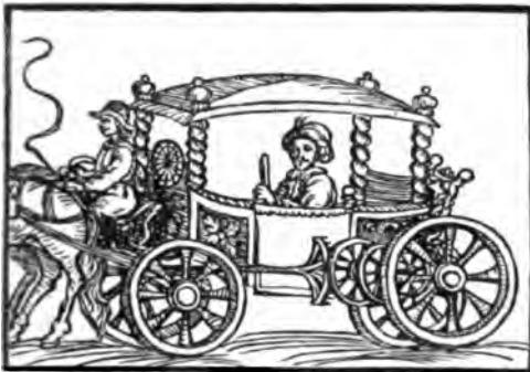
Abb. 807. Wagen mit Wegmesser, nach Capra, 1687. Man erkennt das Zifferblatt des Wegmessers hinter dem Kutschbock.
