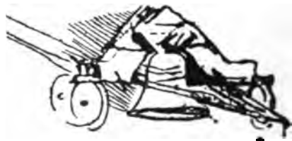
Abb. 314. Aufhängung einer Glocke in gekröpfter Achse, nach Leonardo, um 1495.
