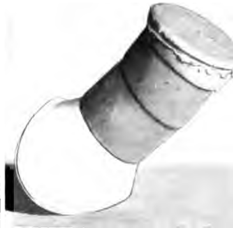
Abb. 178. Trichter eines Fadenfernsprechers von Phil. Reis, um 1860.
