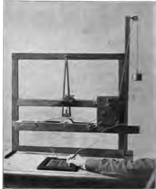
Abb. 749. Telegraph von Morse. Unten der Geber, dahinter der Empfänger.
