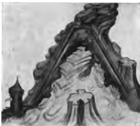
Abb. 351. Heber-Wasserleitung, über einen Berg gelegt; nach Kyeser, 1405.
