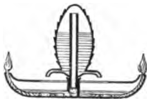
Abb. 419. Öllampe mit konstantem Niveau, um 230 v. Chr.
