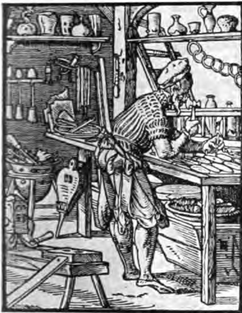
Abb. 306. Glaserwerkstätte um 1568, nach dem Holzschnitt von Jost Amman. Links vorn ein Walzwerk für Fensterblei, dahinter ein Löt-ofen mit LötKolben, andere LötKolben an der Wand hängend.
