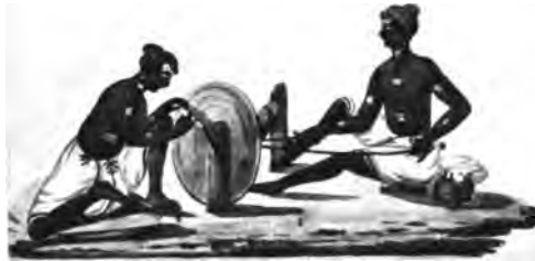
Abb. 146. Schnurzug zum Antrieb einer einfachen Schleifbank nach Art der Universalmaschine. Malerei aus einer indischen Handschrift des Museums für Völkerkunde zu Berlin (Signatur: I. C. 23651, Band 2, Bl. 172). — Der rechts sitzende Mann zieht abwechselnd an den Enden einer Schnur, die um die Achse der Schleifbank geschlungen ist.
