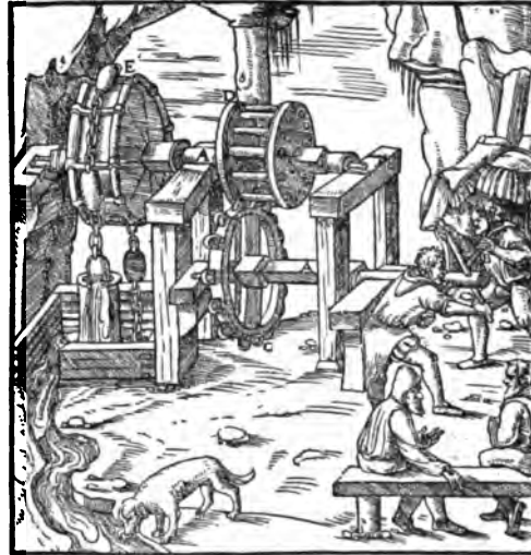
Abb. 544. Schöpfkolbenkette (Paternosterwerk), nach Agricola, 1556.
