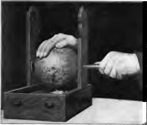
Abb. 169. Elektrisiermaschine von Guericke. Nachbildung im Postmuseum zu Berlin.
