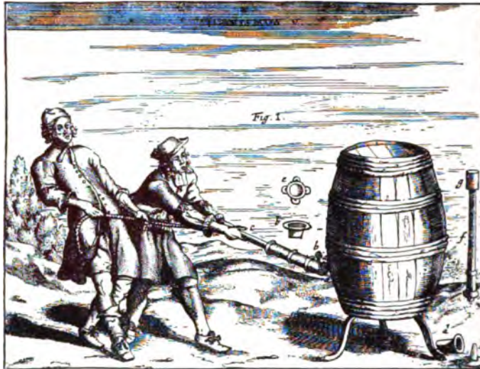
Abb. 451. Guericke's Versuch mit der Luftpumpe, die aus einer Feuerspritze besteht. Nach Guericke, Experimenta nova, 1672.
