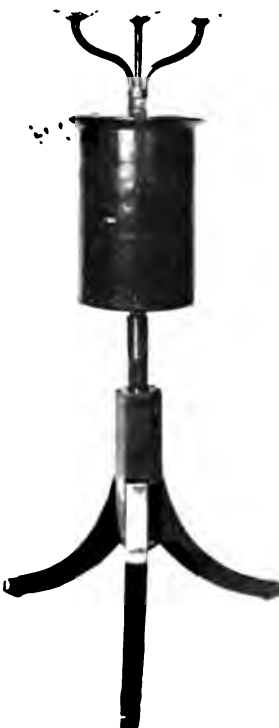
Abb. 239. Kupferner Gasleuchter für komprimiertes Gas. Mathem.-physikalischer Salon in Dresden.
