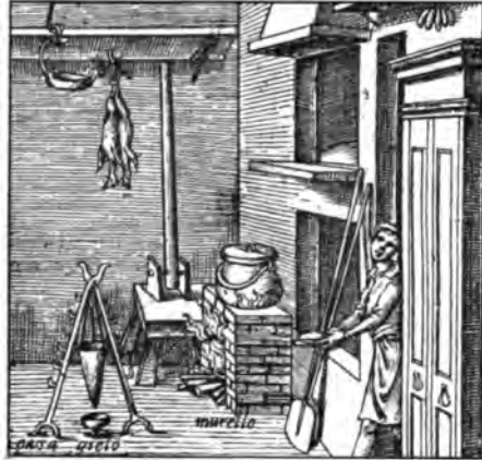
Abb. 393. Hebelknetmaschine, nach Scappi 1570.
