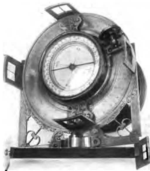
Abb. 474. Bussolendioptr von 1631 mit Mikrometer (rechts oben).
