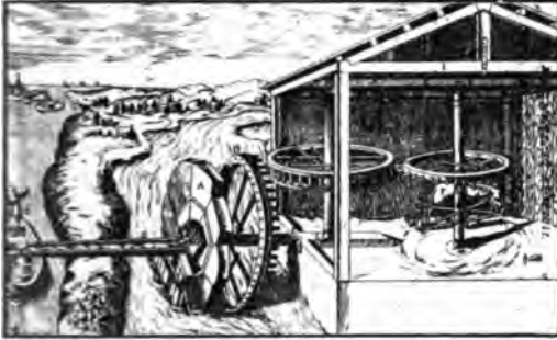
Abb. 547. Radpumpe mit Göpel-Antrieb, nach Zonca, 1607.
