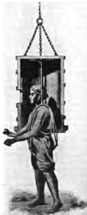
Abb. 741. Taucherglocke 1535, nach Malfatti.
