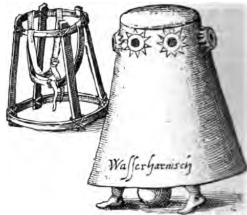
Abb. 742. Taucherglocke nach Keßler, 1616; links die Gurte des Tauchers.
