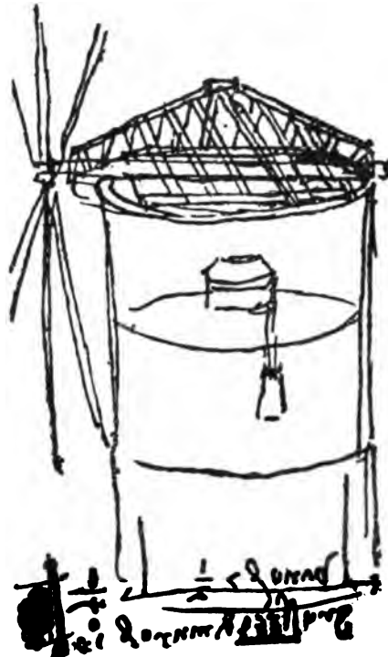
Abb. 824. Windmühle mit drehbarem Dach, nach Leonardo da Vinci, um 1500.
