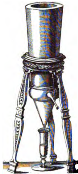
Abb. 367. Hygrometer Ferdinand II., nach Saggi di nat. esp., 1667.
