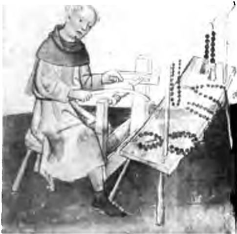
Abb. 148. Drehstuhl eines Rosenkranzmachers zu Nürnberg um 1435.
