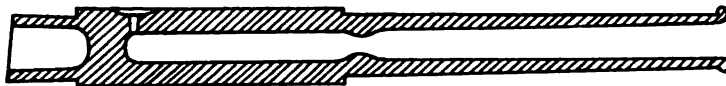
Abb. 279. Schnitt durch die in Hessen gefundene Stangenbüchse von etwa 1395, im Germanischen Museum zu Nürnberg.
