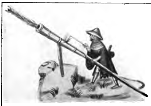
Abb. 280. Schwere Handfeuerwaffe auf Gabelstütze vom Schützen mit dem glühenden Geschützhaken entzündet. Nach Kyesser 1405.
