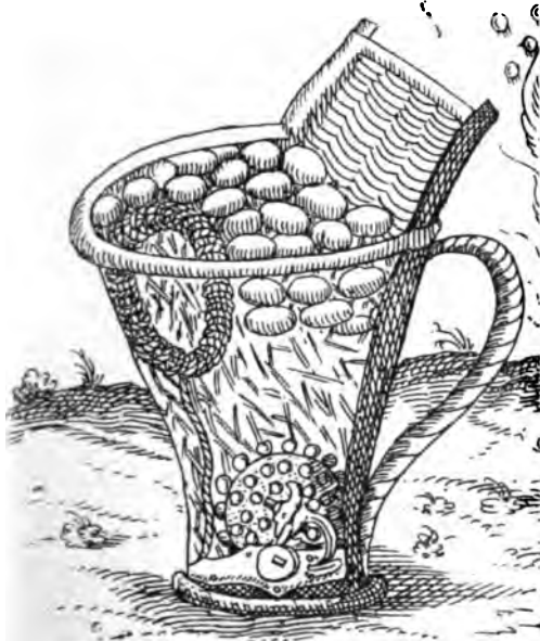
Abb. 360. Höllenmaschine. Unten ein Stein- schloß, das durch Zug an dem oben sicht- baren Kranz ausgelöst wird, 1620.
