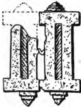
Abb. 253. Darstellung des Vorderteils eines griech.-röm. Geschützes auf dem Pergamon-Altar 180 v. Chr., gezeichnet vom Verfasser. — Man erkennt die beiden Spannrahmen, die beiden gedrehten Spannbündel und — zwischen den Rahmen — die Bahn für den Pfeil.
