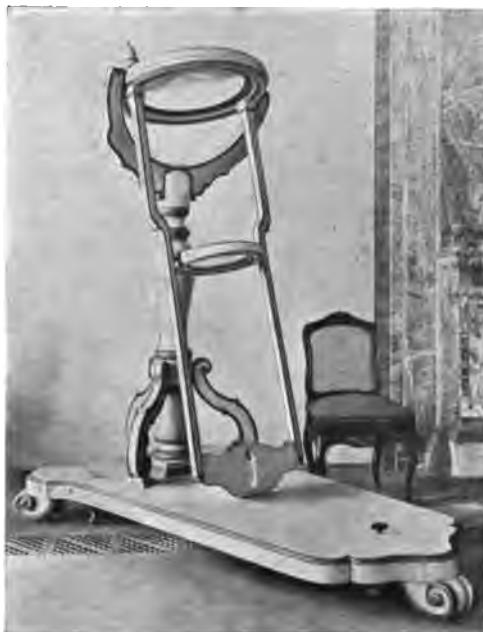
Abb. 428. Großes Brennglas mit Sammellinse von Tschirnhaus. Der Apparat wurde seit 1694 zu den Schmelzversuchen benutzt, die zur Erfindung des Porzellans (s. d.) führten. Original im Mathemat.-physikalischen Salon zu Dresden.
