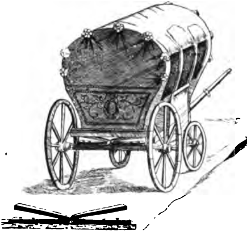
Abb. 783. Reisewagen, auf eisernen Federn gelagert, nach Veranzio, um 1595. Im Vordergrund die Federn noch einmal in vergrößertem Maßstab.
