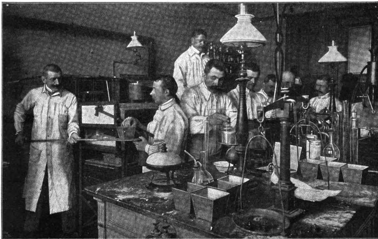
Bachversuche im elektrischen Backofen und Bestimmung der Gärkraft der Hefe.
