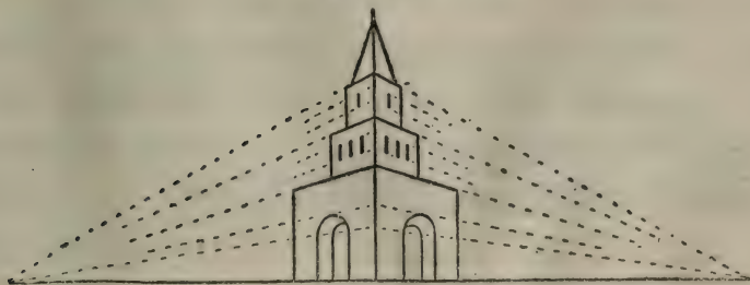
圖 139 塔的透視描繪,塔基在观察者的眼睛水平之上
