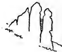
圖 214 冰冻風化作用(水冻结在岩石縫中的作用)
