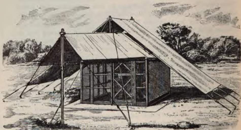
Fig. 102. Zerlegbares mückensicheres Expeditionszelt mit Sonnensegel. Nach F. Plehn.
