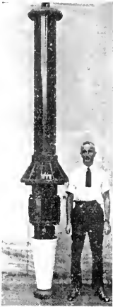
Fig. 5. 400,000 volt test Condenser Bushing
