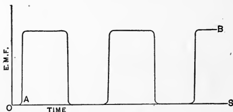
FIG. 42.—INTERMITTENT E. M. F. UNIDIRECTIONAL.
