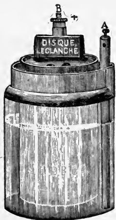
FIG. 6.—LECLANCHÉ VOLTAIC CELL.
