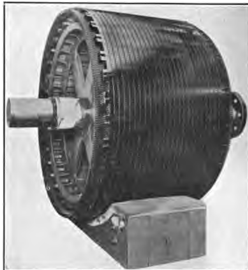
FIG. 62.—Main Motor Rotor for U. S. S. New Mexico
