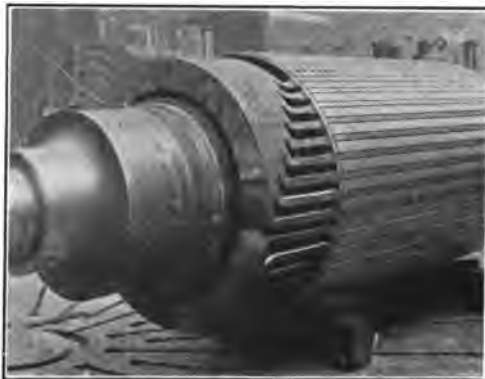
FIG. 106.—U. S. S. Tennessee : Main Generator Rotor
