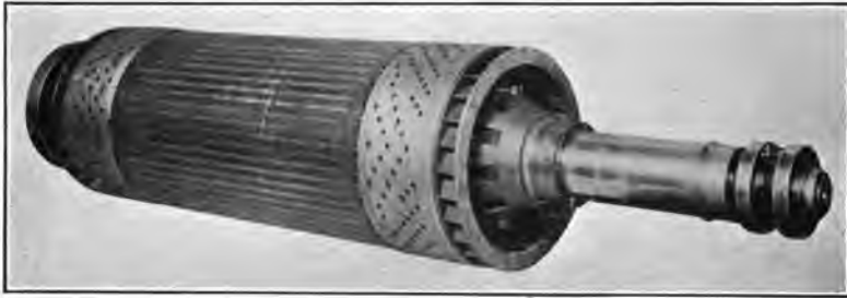
FIG. 42.—Generator Rotor for U. S. S. Jupiter
