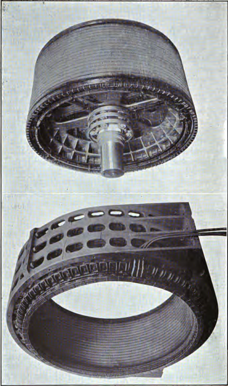
FIG. 44.—Rotor for U. S. S. Jupiter
