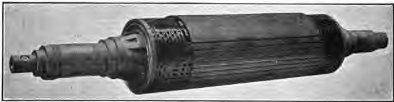
FIG. 56.—Rotor of Main Generator for U. S. S. New Mexico
