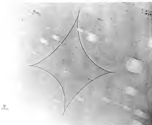
Abb. 1. „Streu sternchen“ nach Scheffels als Beispiel für Kontrast, der durch Schwankungen der Stromdichte im Objekt verursacht wird.
