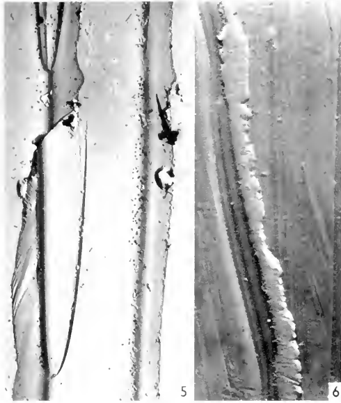
Abb. 5. Glasbruch mit Lanzettsprüngen.
