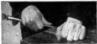
Fig. 187. Laying the Bur.
