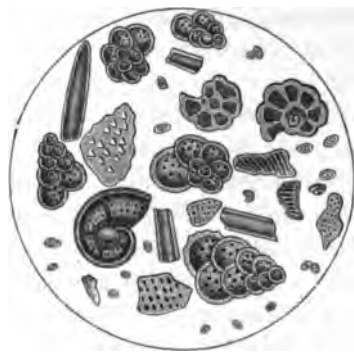
Fig. 100. Geschlammte Schreibkreide von Meudon mit Foraminiferen (Textularia, Globigerina, Rotalia). 300malige Vergrößerung. Nach Zittel.
