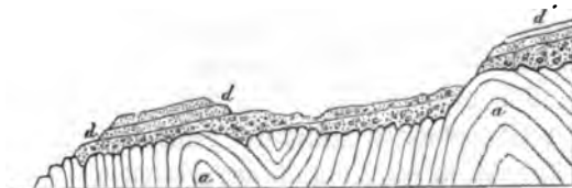
Fig. 130. Devonischer Sandstein d überlagert silurische Schiefer a discordant. Siccar Point in Berwickshire. Nach Lyell.
