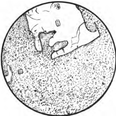
Fig. 8. Vitrophyr. Goatfell. Arran. Quarz (stark corrodirt) und Feldspath in mikrolithenreicher Glasbasis. Vergr. 15 : 1.
