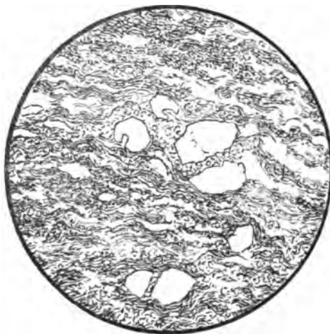
Fig. 76. Sericitgneiss, senkrecht zur Schieferung. Forst Eulenbaum zwischen Rossert und Staufeu. Taunus. Vergr. 30:1.
