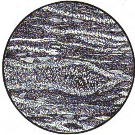
Fig. 30. Gabbroschiefer. Siebenlehn, Sachsen. Flasriger Wechsel von Hornblende- und Labradorlagen mit grossen Augen von pillitisch umgewandeltem Olivin und kleinen Resten von Diallag. Vergr: 30:1.
