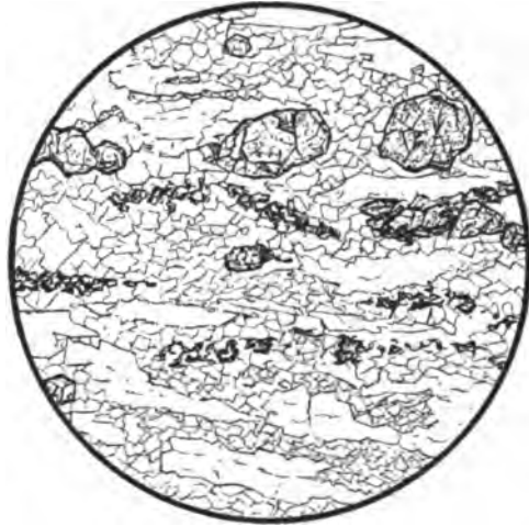
Fig. 86. Hercynit-Granulit, senkrecht zur Schieferung. Hartmannsdorf, Sachsen. Vergr. 15 : 1.
