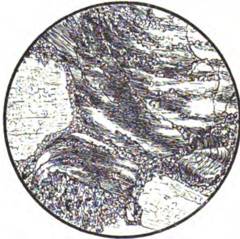
Fig. 18. Stark gepresster Granitit, sogen. Augengneis. Malmagen, Herjeådalen, Schweden. Vergr. 15 : 1. Nic. +.
