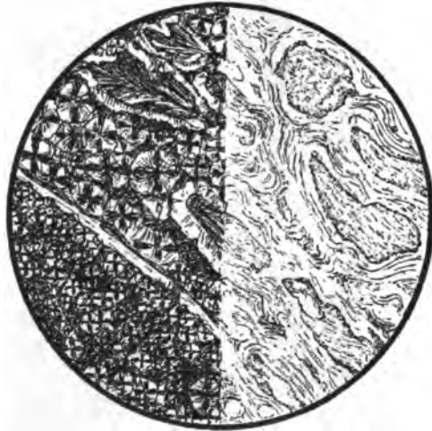
Fig. 44. Felsoliparit mit Sphärolithen und gepressten Glaskugeln. Fölcsva Litzka, Ungarn. Vergr. 30:1. Die linke Hälfte bei + Nic.
