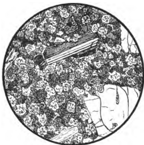
Fig. 50. Pyroxenquarzporphyr. Steinberg bei Taucha, Sachsen. Grundmasse mikropoikilitisch. Einsprenglinge Quarz, Labradorit, Orthoklas und Bronzit. Vergr. 30:1. Nic. +.
