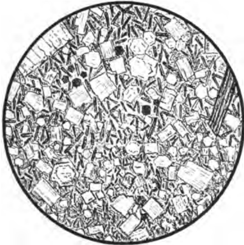
Fig. 53. Nephelinitoider Phonolith. Spitzberg bei Oberwiesenthal, Erzgebirge. Vergr. 50: 1.
