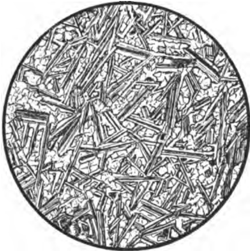
Fig. 56. Basalt. Hurney Falls, Shasta Co., Cal. Structur doleritisch. Vergr. 30:1. Nic. +.
