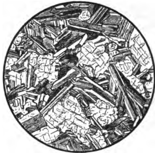
Fig. 58. Bronzidiabas. York, Pa., U. S. A. Die Feldspäthe bei + Nic. gez. Vergr. 30 : 1.
