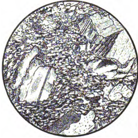
Fig. 17. Aus einer Quetschzone des Granitits von Ilsviken bei Dronthjem. Vergr. 15 : 1. Nic. +.
