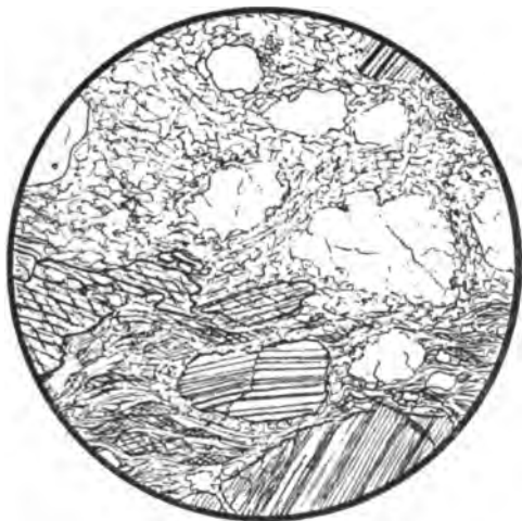
Fig. 85. Ortho-Amphibolgneiss, senkrecht zur Schieferung; Plagioklas bei + Nic. Tohara bei Toyamamura, Inagori, Shinano, Japan. Vergr. 15:1.
