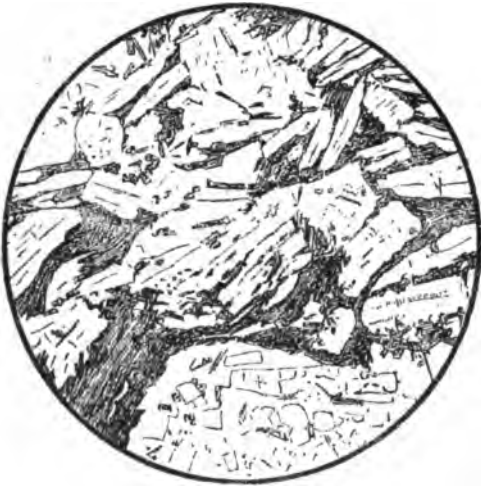
Fig. 25. Grenzfacies des Lujaurit. Umptek, Kola. Aegirin (schraffirt) in Flasern mit Feldspath und Nephelin. Vergr. 15:1.
