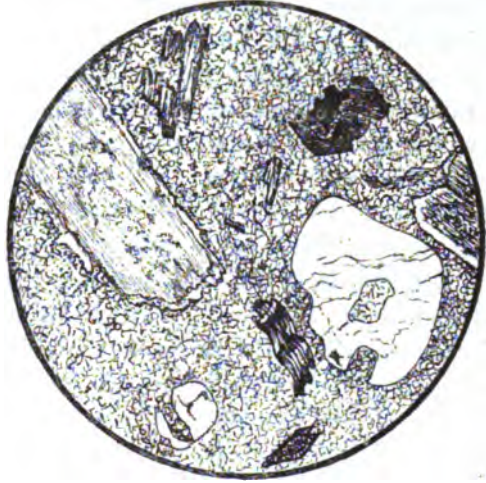
Fig. 31. Granitporphyr, mikrogranitisch. Ernsthofen, Odenwald. Vergr. 30:1.
