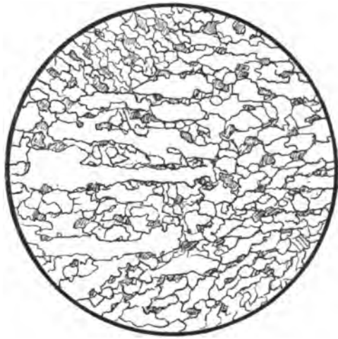
Fig. 81. Psammitgneiss, senkrecht zur Schieferung, discordante Parallelstructur noch kenntlich. Säge im Wernestgrund. Blatt Petersthal-Reichenbach, Schwarzwald. Vergr. 15:1.
