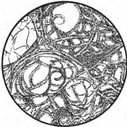
Fig. 46. Felsitpechstein mit Quarzeinsprenglingen. Corbitz, Sachsen. Die krystalline Umwandlung des Glases folgt den perlithischen Bahnen. Vergr. 30:1.
