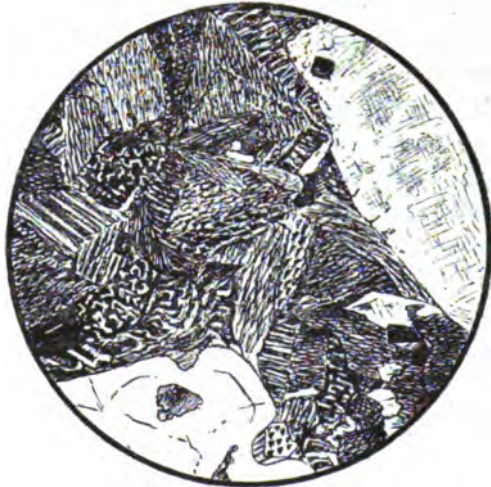
Fig. 32. Grundmasse bei + Nic. Granitporphyr, granophyrisch. Schlüchthal, Schwarzwald. Vergr. 30:1.
