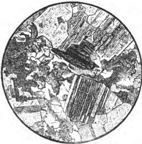
Fig. 16. Granitit, sogen. Protogin, wenig gepresst. Ilsviken bei Drontheim. Vergr. 15 : 1. Nic. +.
