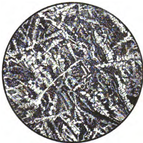
Fig. 36. Bostonit. Sitio do Covado, Serra de Monchique, Portugal. Wesentlich mikroperthitischer Feldspath, quer zu M geschnitten. Vergr. 30:1. Nic. +.
